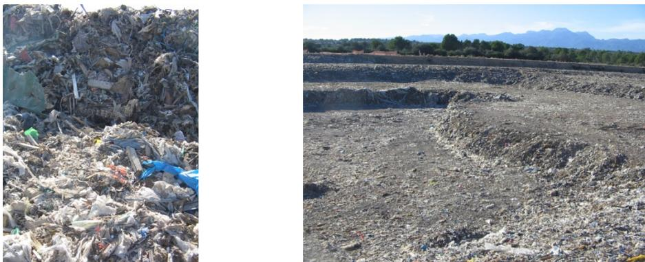
**Imagen 3-1. Diferencia entre el residuo original vertido (izq.) y el rechazo del cribado (dcha.)**
