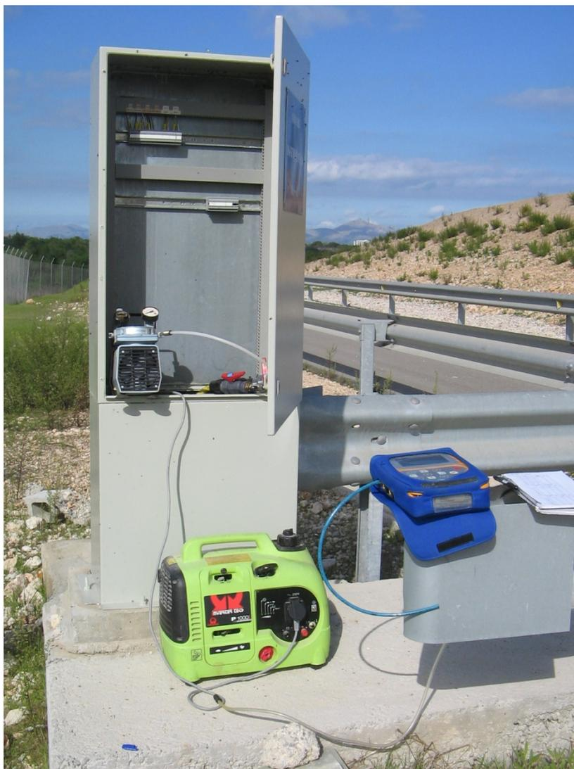
**Imagen 3-9. Conexión de la bomba de vacío a la manguera de unión al tomamuestras**
