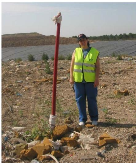
Imagen 3-6. Tubo de la placa de asiento después de un tiempo en el vertedero
