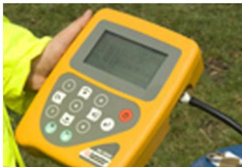
**Imagen 3-8. Equipo analizador de gases portátil GA2000**
