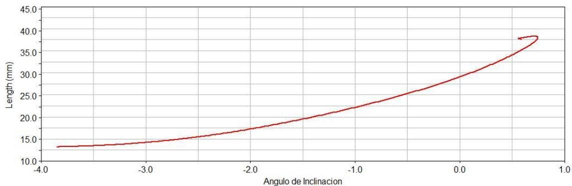
Figura 2.63: Ángulo de inclinación de la rueda trasera derecha durante el evento del skid-pad
