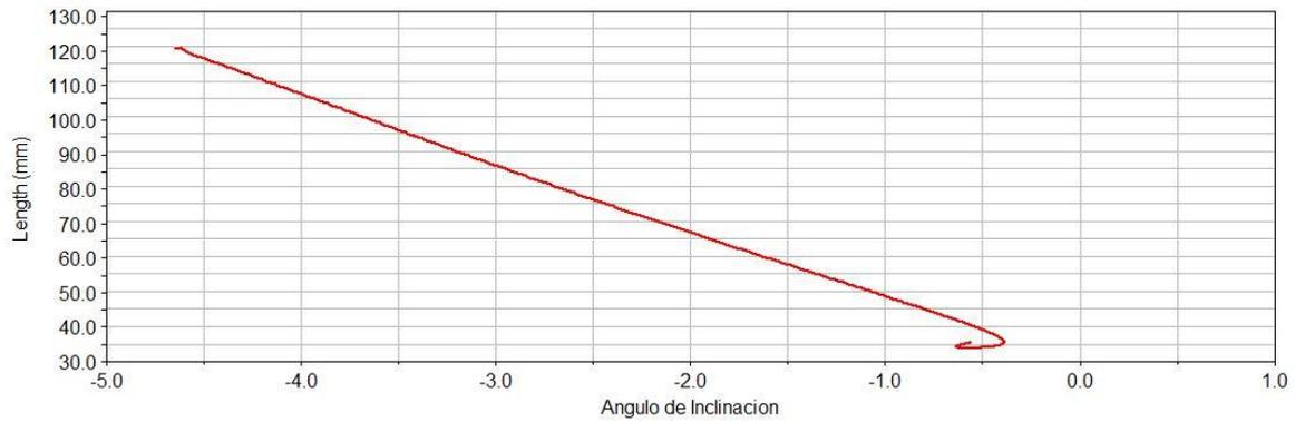
Figura 2.60: Ángulo de inclinación de la rueda delantera izquierda durante el evento del skid-pad
