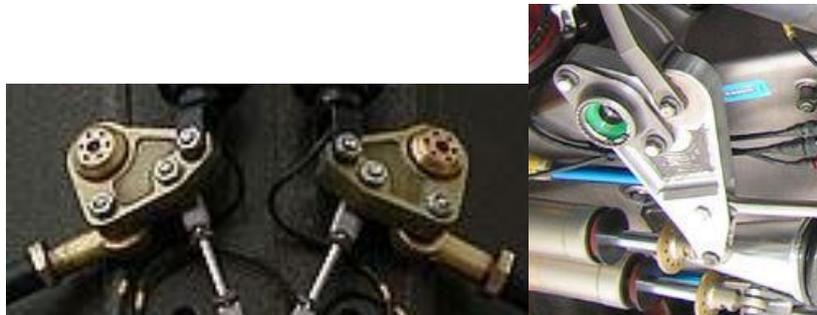
*Figura 2.11: Ejemplos de balancines usados en Fórmula 1*
