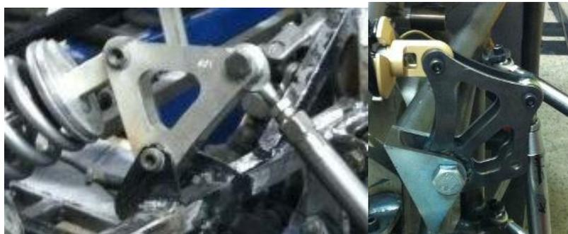
*Figura 2.12: Balancines usados en FSAE*
