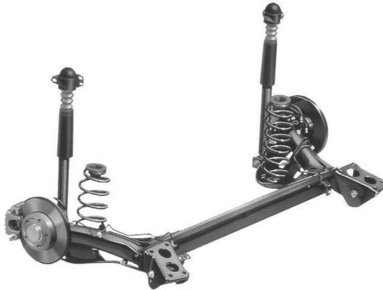
*Figura 1.6: Ejemplo suspensión semiindependiente o semirrígida*
