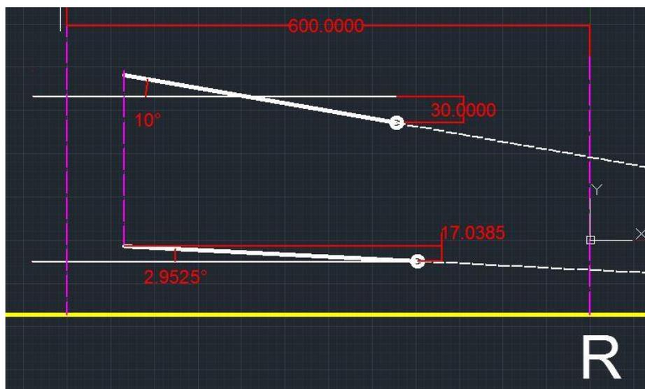
Figura 2.52: Posición inicial de los brazos de la suspensión trasera para conseguir una variación del ancho de vía mínimo
