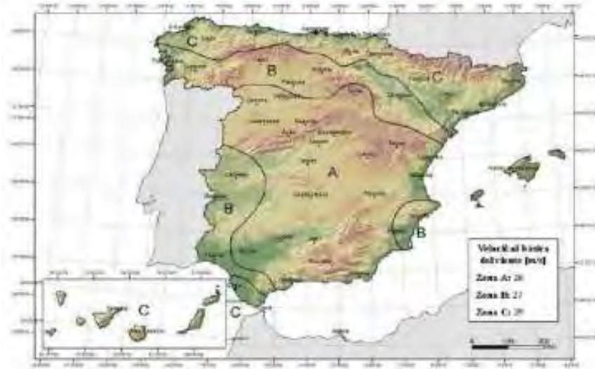
Figura D.1 Valor básico de la velocidad del viento,  $v_b$
