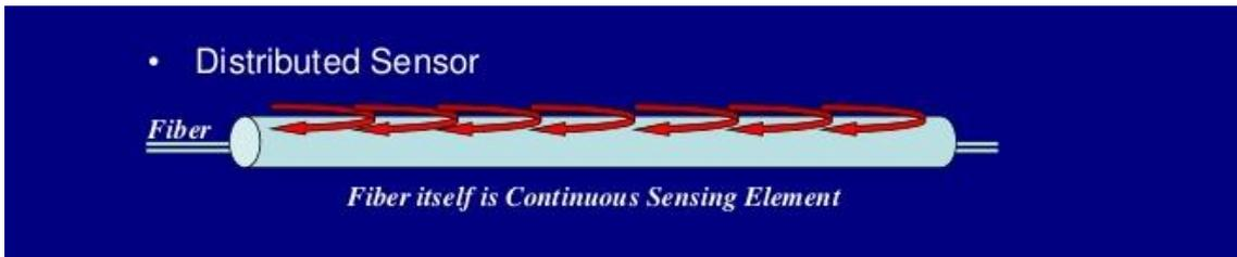
Figura 7: Esquema sensor distribuido.
