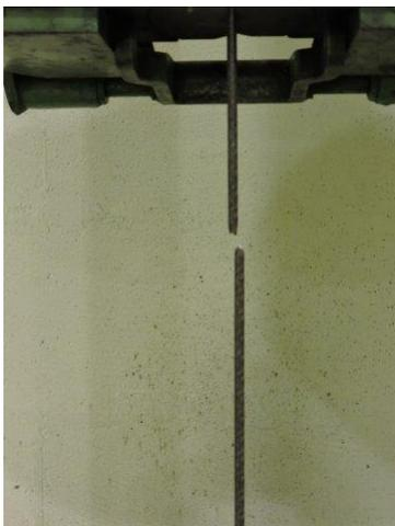
*Fig. 6.4. 2: Ensayo tensión deformación acero pasivo rotura probeta 1*
