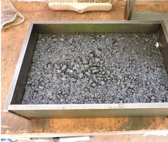
**Fig. 6.2. 13: Mezcla bituminosa compactada1**
