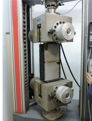
**Fig. 6.2. 16: Probeta en máquina de ensayo cíclico**
