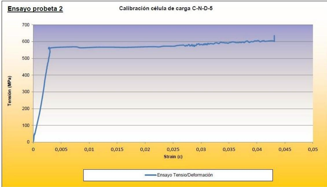
Fig. 6.4. 6: Ensayo tensión deformación acero pasivo rotura probeta 2
