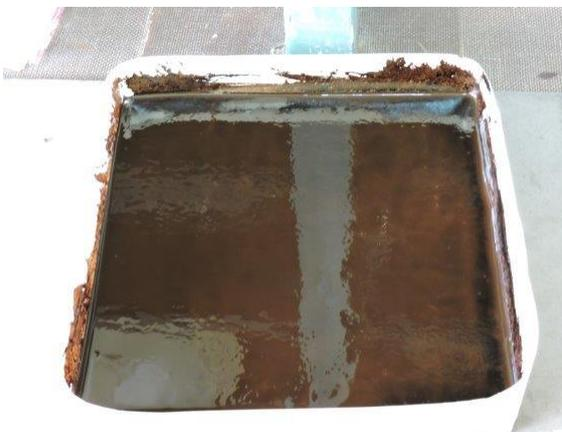
*Fig. 6.2. 3: Proceso de rotura de la emulsión*
