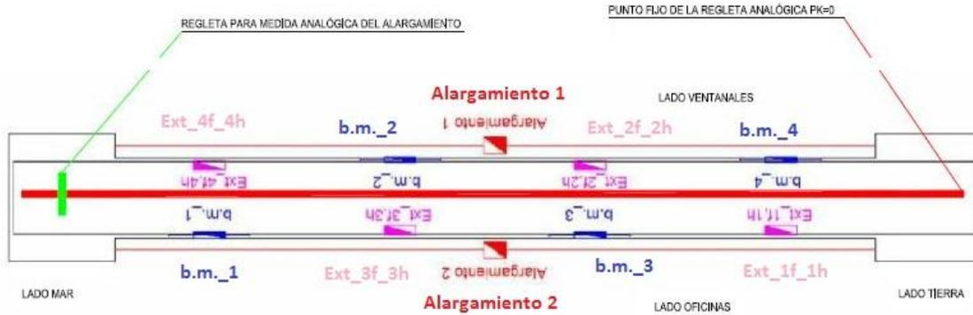
Fig. 6.1.11. 12: Instrumentación inicial en probeta
