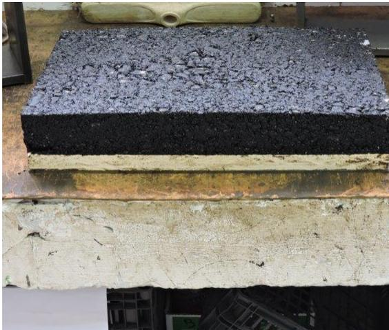
**Fig. 6.2. 14: Desencofrado probeta mezcla bituminosa**
