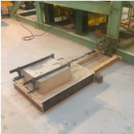
*Fig. 6.5. 1: Ensayo para la obtención del coeficiente de rozamiento de la arena*
