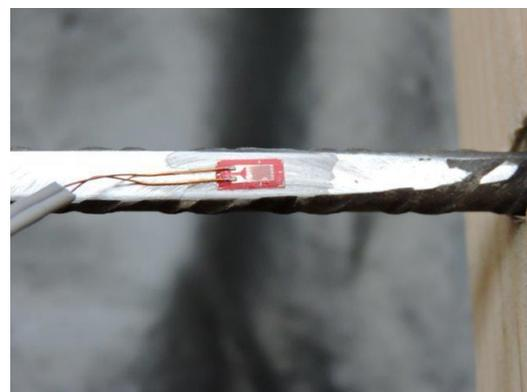
Fig. 6.1.11. 4: Extensómetro unidireccional en acero pasivo
