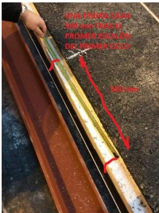
Fig. 6.3. 1: Mapeo de fisuras tras el primer escalón de la primera etapa del primer ciclo
