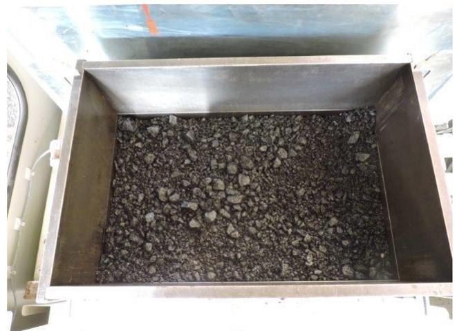
**Fig. 6.2. 12:** Mezcla bituminosa compactada
