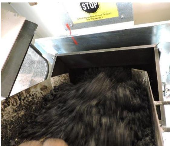
**Fig. 6.2. 9:** Vertido de la mezcla bituminosa en el molde de compactación
