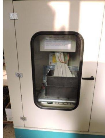
**Fig. 6.2. 10:** Compactación de la mezcla en la probeta de ensayo
