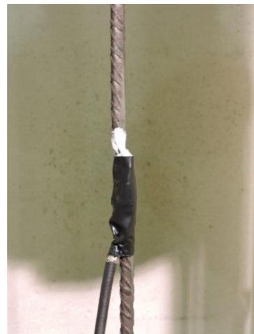
*Fig. 6.4. 4: Ensayo tensión deformación acero pasivo rotura probeta 2*
