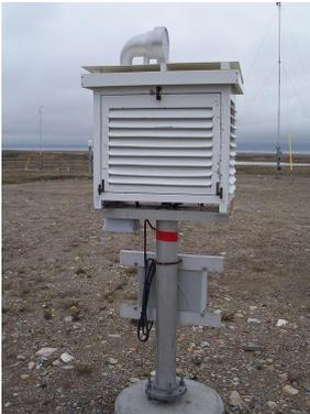
Fig.5.3.3. 1: Pantalla Stevenson para medición de temperatura
