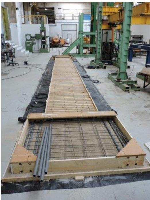
*Fig. 6.1.11. 7: Probeta de ensayo a falta de armadura superior*
