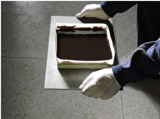
*Fig. 6.2. 2: Ligante extendido en chapa de probeta de ensayo*
