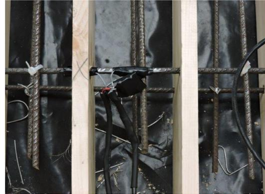
*Fig. 6.1.11. 8: Extensómetro uniaxial en paño colaborante+junta*
