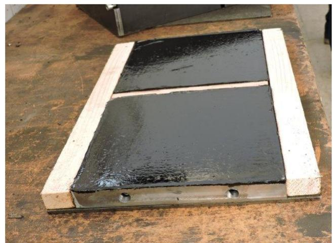
*Fig. 6.2. 6: Chapas de soporte con la emulsión bituminosa de adherencia*
