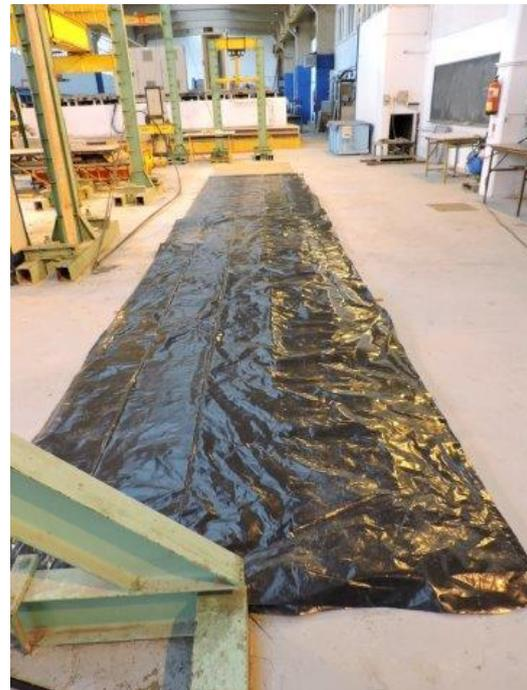
Fig. 6.1.11. 3: Capas de plástico sobre cama de arena
