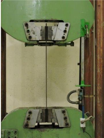
*Fig. 6.4. 1: Ensayo tensión deformación acero pasivo probeta 1*
