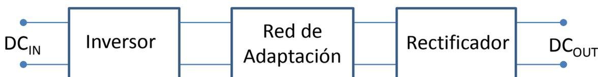
**Figura IV.1: Diagrama de bloques de un convertidor DC-DC resonante.**
