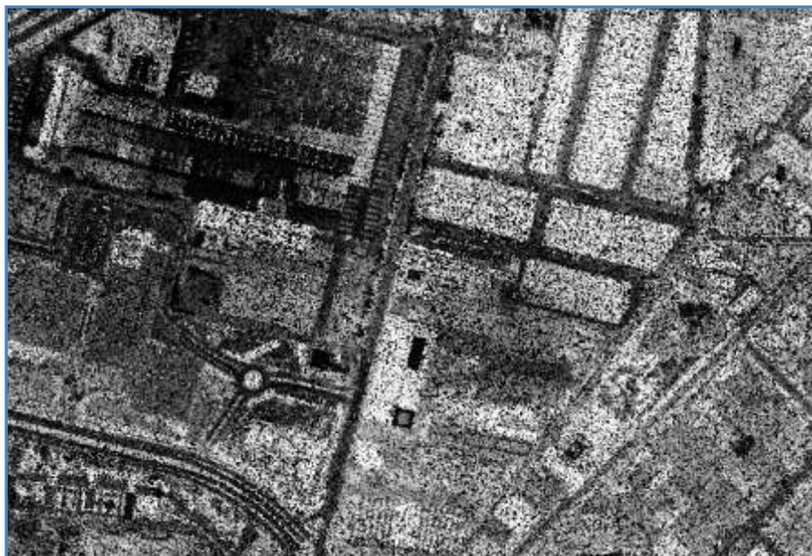
Figura 1.6. Nube de puntos simbolizado según su valor de intensidad
