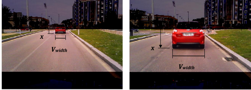
Figura 2.7: Variación de la anchura del vehículo V_{width} con respecto a su posición vertical en la imagen x .
