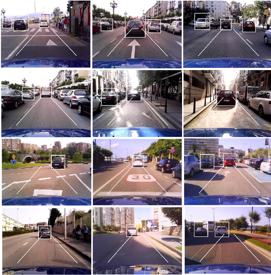
Figura 2.9. Ejemplos de los resultados de la generación de hipótesis incluídas aquellas fuera de la ROI.
