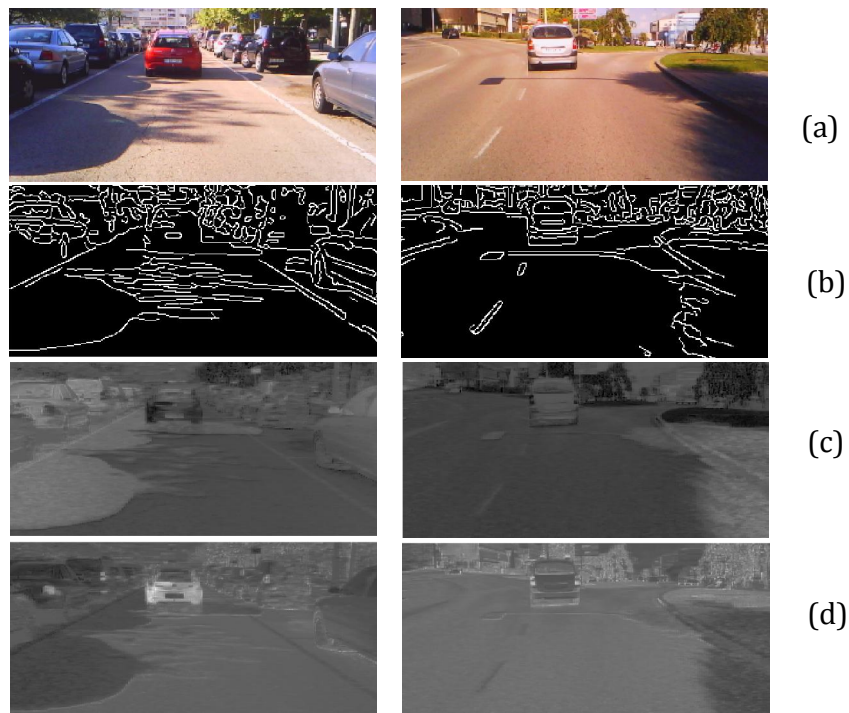
Figura 4.4. Dos escenas en presencia de sombras: (a) imagen original, (b) mapa de bordes obtenido mediante el operador Canny y las correspondientes componentes normalizadas (c) azul y (d) roja.
