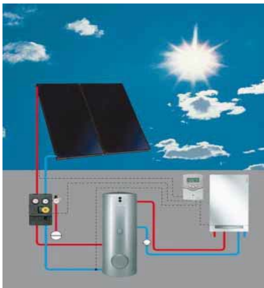
Imagen 46: Componentes de una instalación solar [1]
