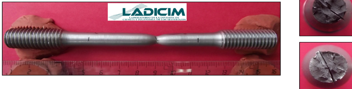
Figura 3.8 – Probeta del acero S690Q tras el ensayo de tracción.
