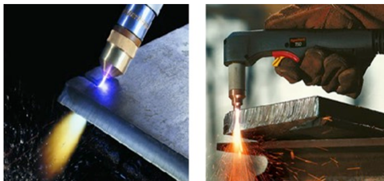
Figura 1.35 – a) Sistema de corte automático b) Sistema de corte manual [43].
