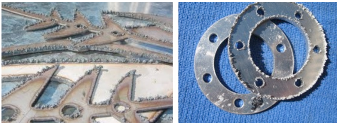
Figura 1.36 – Elevada cantidad de escoria adherida en la parte inferior de una acero austenítico debido a una excesiva velocidad de corte o escasa corriente [44,45].
