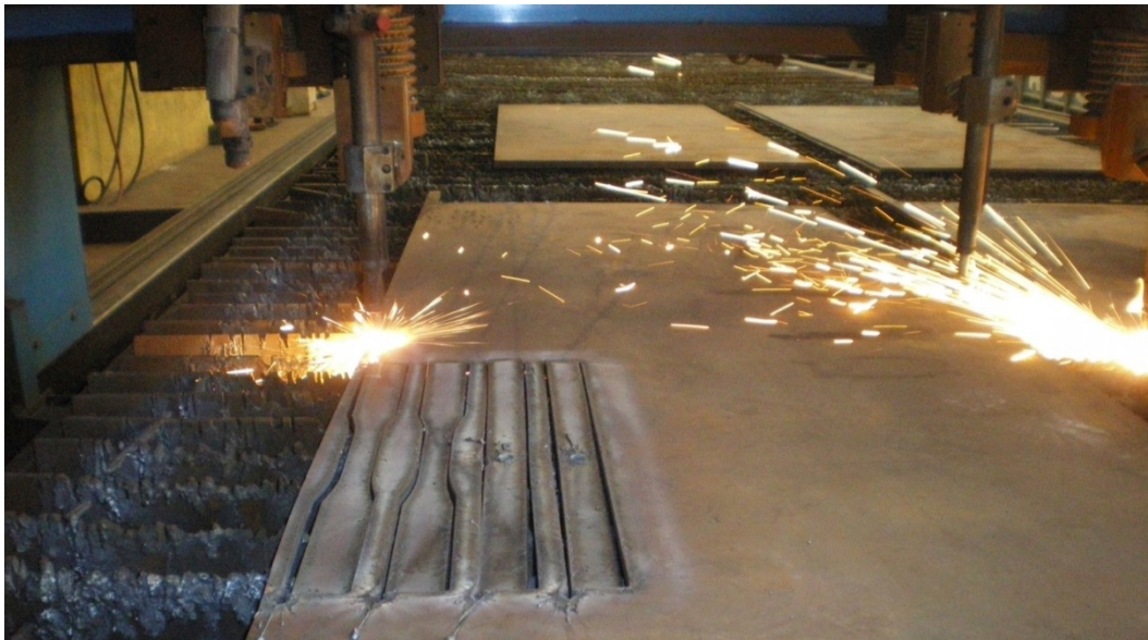
Figura 3.15– Proceso de fabricación de las probetas de fatiga por oxicorte.
