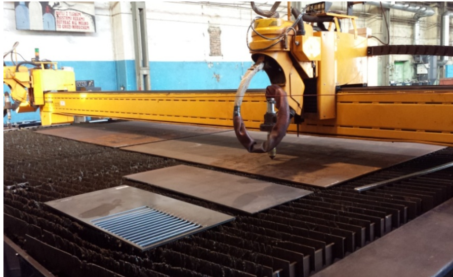
Figura 3.16 – Vista de la mesa de corte por plasma utilizada.
