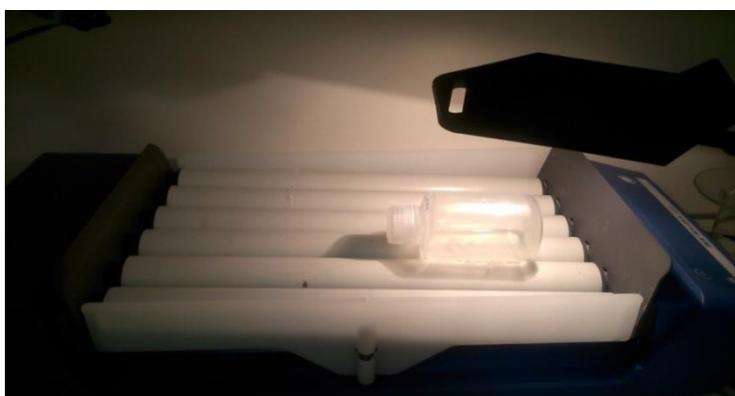
**Figura 2.1. Disolución de la PCL en el disolvente con ayuda de un agitador de rodillos**
