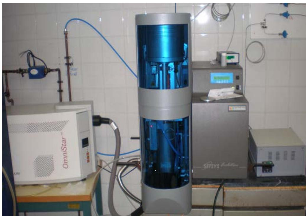
**Figura 3.2.1: Equipo termogravimétrico conectado en serie a un espectrómetro de masas**
