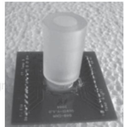
Fig. 9 - Matriz de 18 microelectrodos usada en [7]
