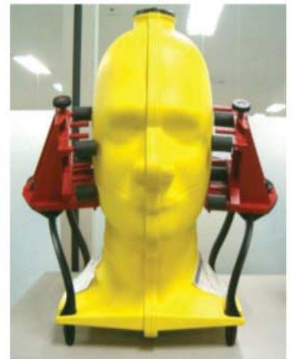
**Fig. 4- Cabeza artificial (*phantom head*) para poder estudiar interacciones radiación-cabeza humana [2]**
