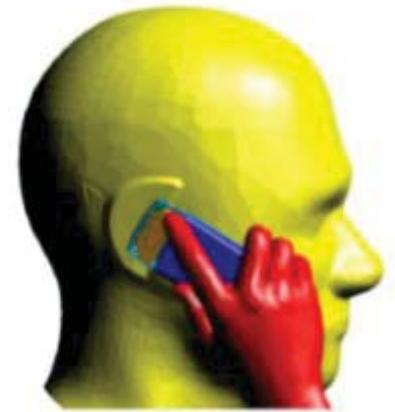
Fig. 6 - La eficiencia de radiación y de antena se pueden ver reducidas por la presencia de factores externos como la cabeza y la mano humana. La utilización de simuladores electromagnéticos resulta clave para un análisis sistemático [2]
