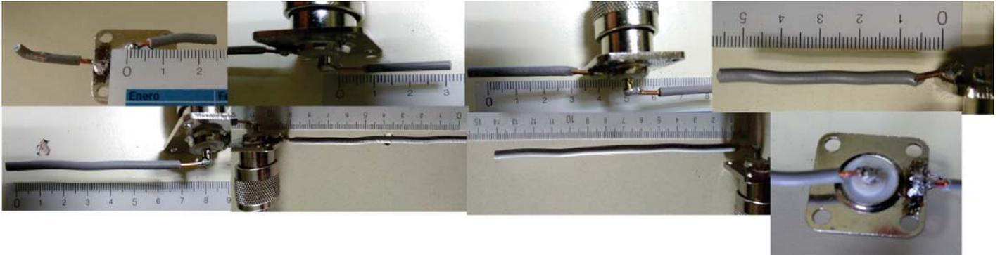
*Fig. 46 - Antenas construidas para 3 GHz, 2,5 GHz, 2 GHz, 1,5 GHz, 1 GHz, 800 MHz, 500 MHz y detalle de las soldaduras realizadas entre el conector y los polos de la antena*
