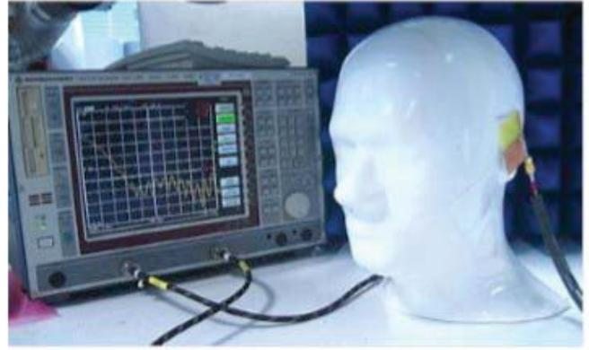
Fig. 5 - Analizador de redes para la medida del coeficiente de reflexión de antenas. El ejemplo muestra la medida de una antena enganchada a la mejilla de un phantom head (maniquí de cabeza humana) que contiene líquidos que emulan el tejido humano [2]
