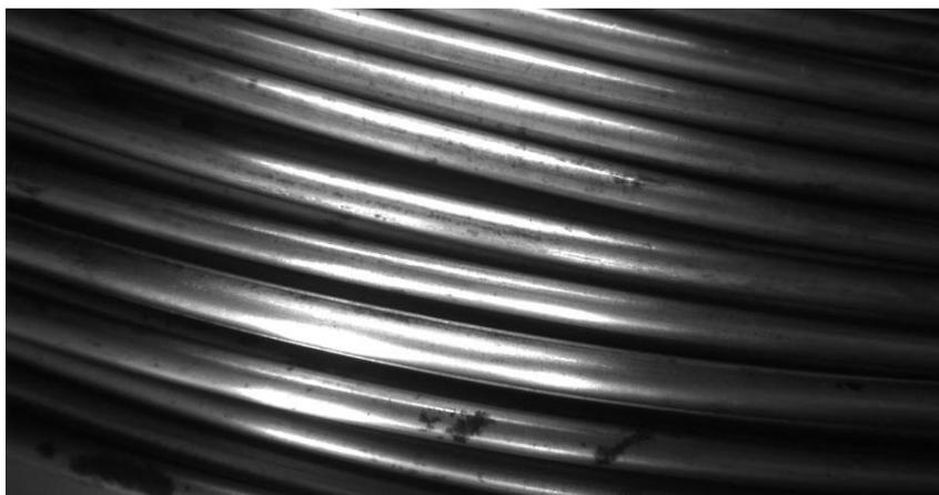
(Ilustración 9.22 – Imagen original capturada de recortes de alambión, con uno con defecto de cordón o bigote en la parte inferior)
