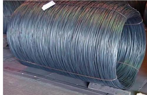
(Ilustración 6.3 - Bobina de alambrión aguardando su expedición al cliente)
