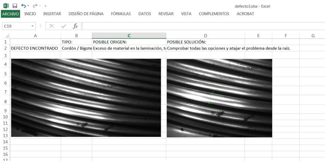
(Ilustración 9.32 – Generación del informe en Excel para defecto de tipo Cordón encontrado)
