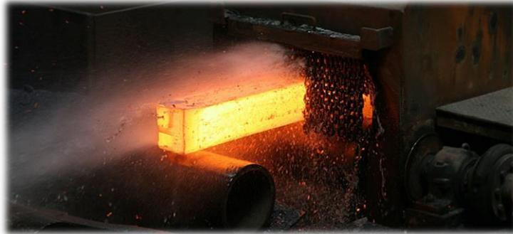
(Ilustración 6.1 -Palanquilla de sección cuadrada a la salida de la artesa)
