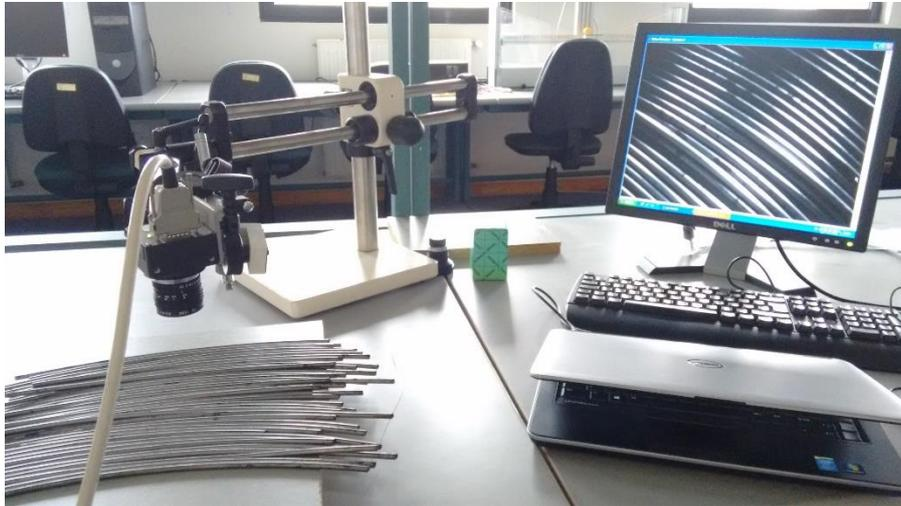
(Ilustración 9.12 – Sistema de visión utilizado en el laboratorio para realizar la programación)
