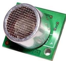
Se trata de un sensor de pequeño tamaño y mínimo consumo que destaca por tener interfaz serie e interfaz I2C. Además utiliza un único transductor tanto para transmitir la ráfaga ultrasónica como para recibir el eco de la misma y poder así medir la distancia. El interfaz serie tiene un formato estándar de 9600 baudios, un bit de comienzo de ocho de datos y un bit de parada. El nivel de tensión es a nivel TTL lo que permite conectarlo a
