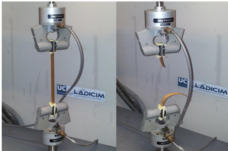
Figura 5.21. Fase inicial (izquierda) y final (derecha) del ensayo de tracción
