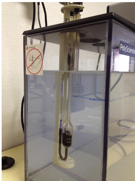
Figura 5.16. Detalle del viscosímetro en el interior del baño de circulación
