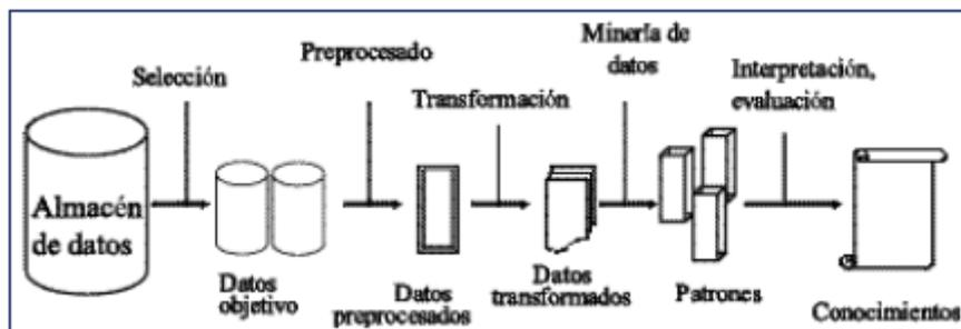
Figura 12: Modelo clásico del proceso DCDB
