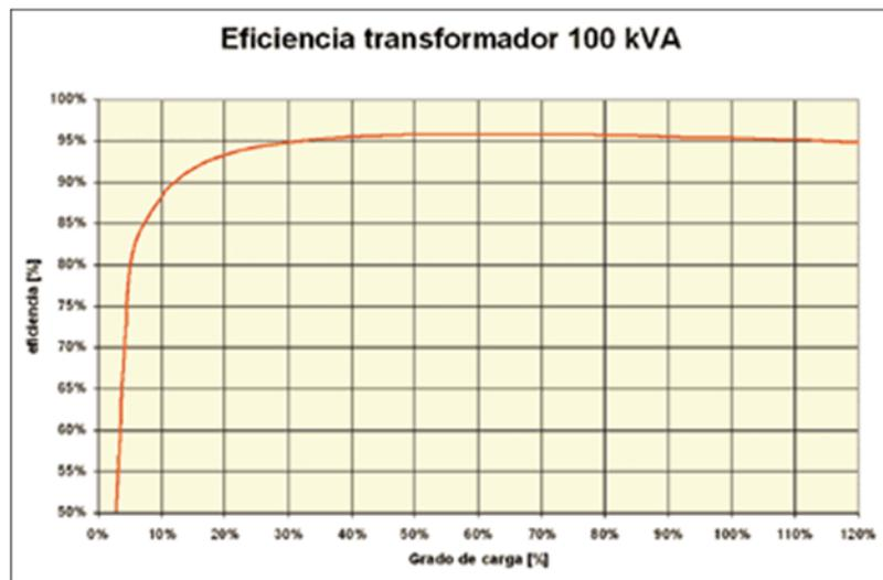
Figura 3.5 Eficiencia de un transformador
