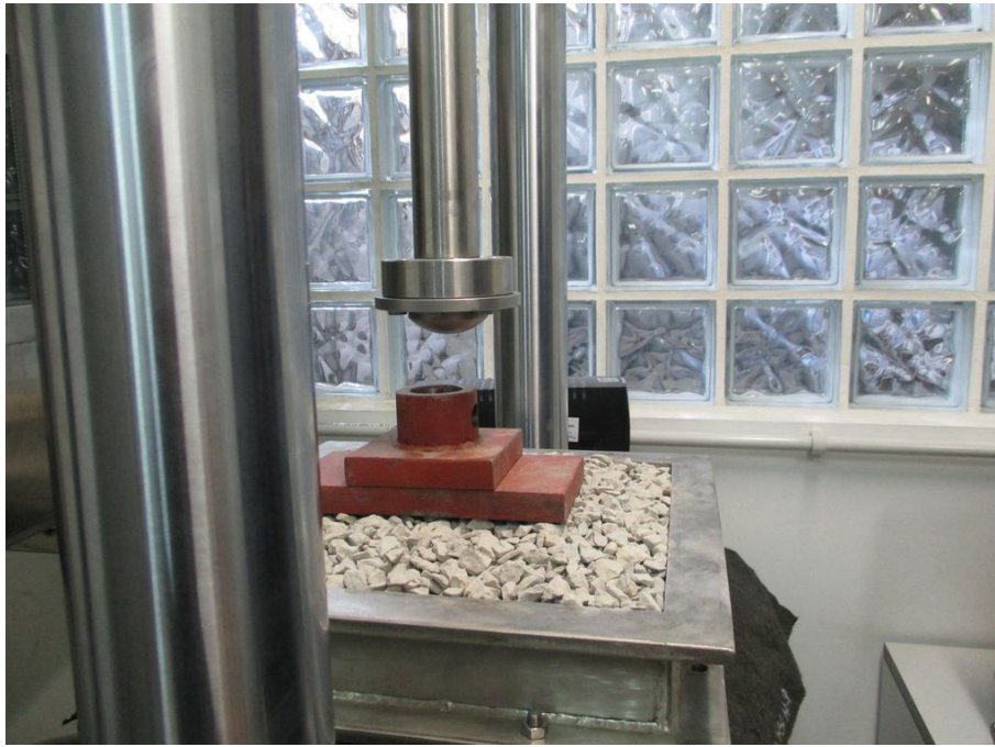
Figura 11.- Montaje inicial del ensayo ISO 10722.
