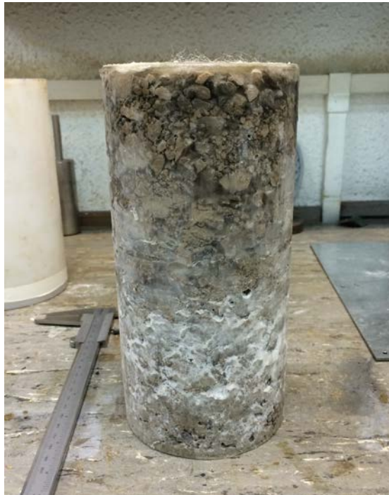
Figura 6.- Probeta para ensayo triaxial tras 1 día de congelación
