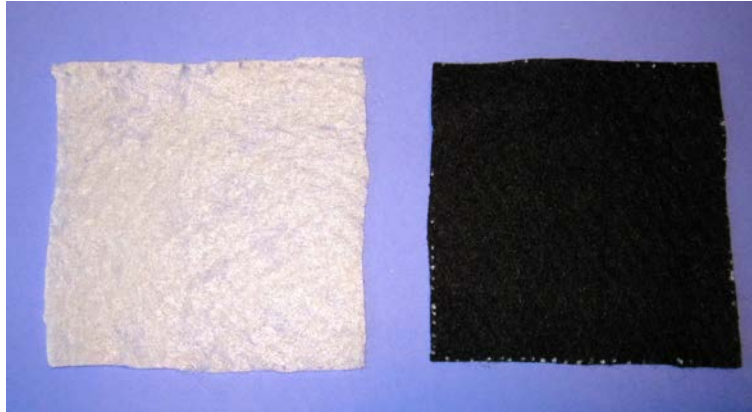
Figura 5.- Geotextiles empleados en el análisis. Geotextil A (gris) y Geotextil B (negro)
