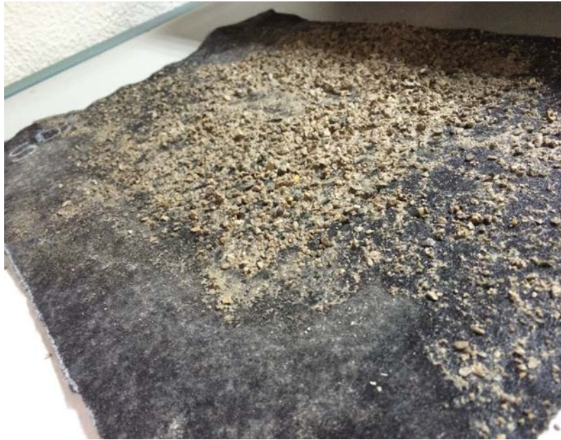
Figura 33.- Apariencia del geotextil tras la simulación del daño hidráulico
