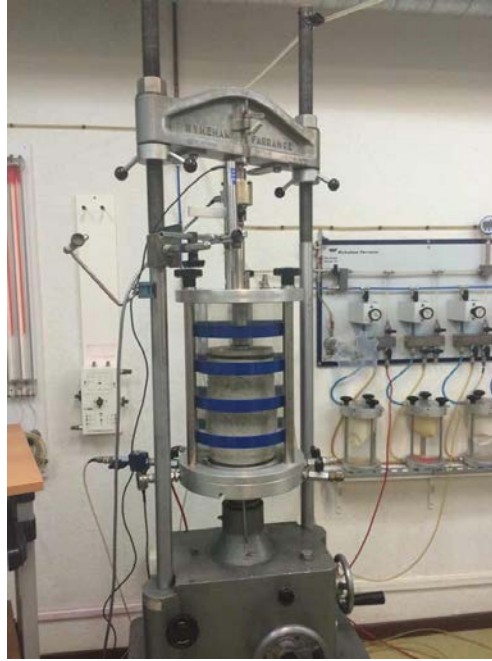
Figura 8.- Fase de rotura de un ensayo triaxial.
