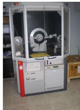
Figura 3: Difractómetro de Rayos X Bruker D8 Advance.
