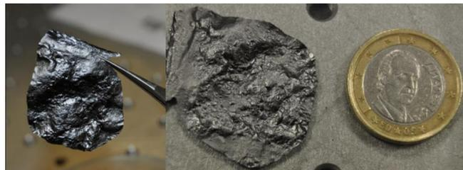
Figura 2: Imágenes de una lámina de óxido de grafeno conductora, sintetizada en nuestro laboratorio.
