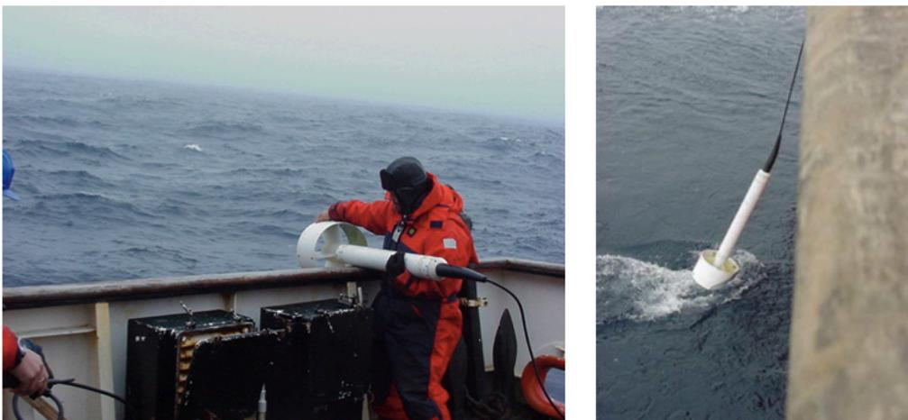
**Figura 7:** Arriado del magnetómetro de protones por estribor. [15]
