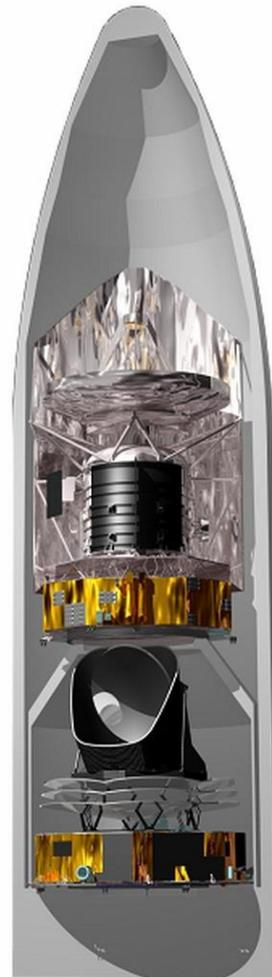
**Figura 6.** Ilustración de la configuración de lanzamiento de la lanzadera Ariane 5 ECA encargada de poner en órbita el Observatorio Espacial Herschel (parte superior) y el satélite Planck (parte inferior).
