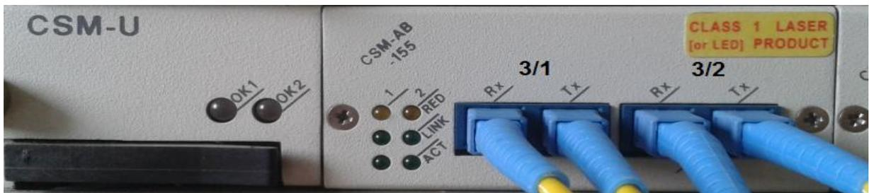
Figura 4.12. Conectores de fibra en el slot CSM
