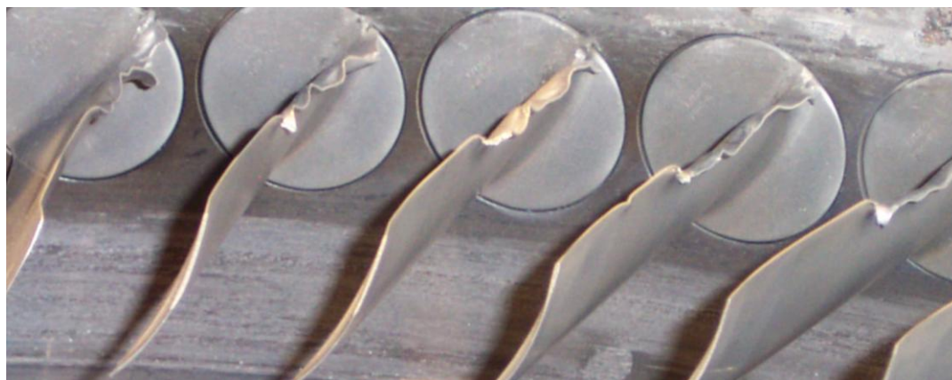
Figura 22. Desgaste de los álabes de una turbina de gas.
