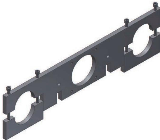
*Figura 7.4. Sujeciones del cepo.*
