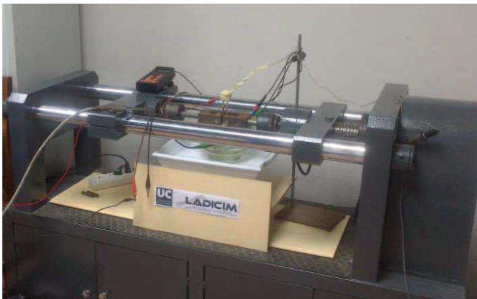
Figura 6.2. Máquina de tracción lenta horizontal existente en las instalaciones del LADICIM
