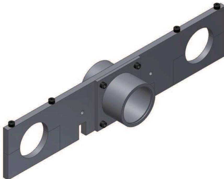
*Figura 7.8. Cubo de rodamiento unido al cepo.*
