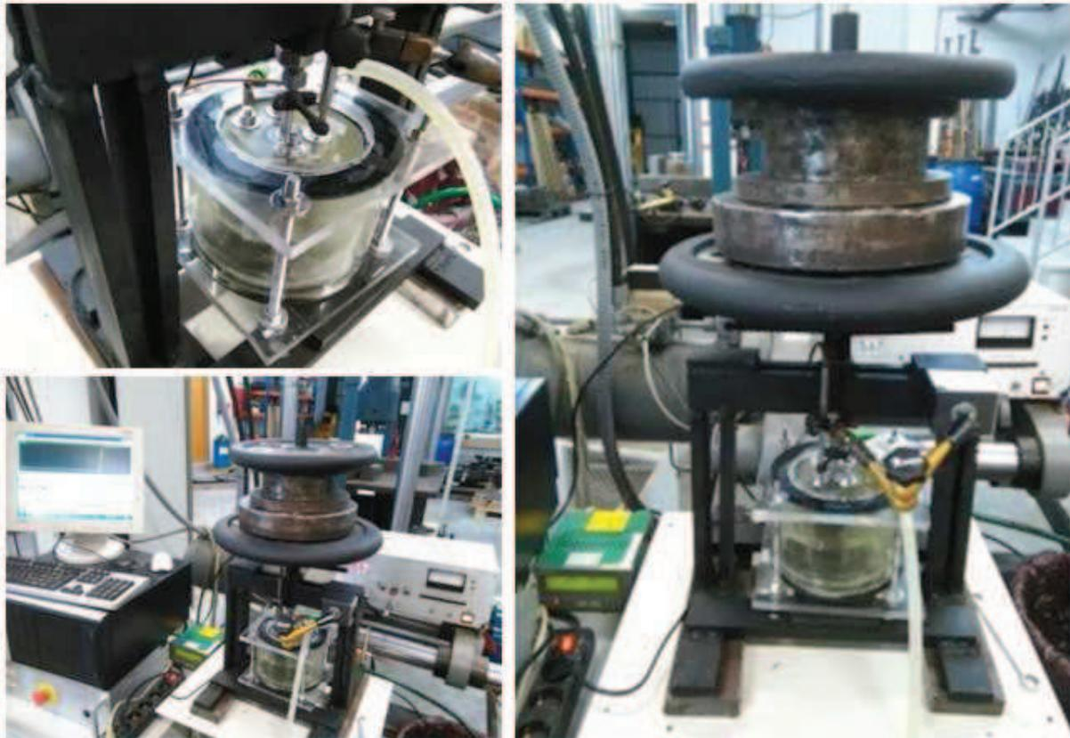
*Figura 10.1. Dispositivo experimental para la realización de ensayos Small Punch en condiciones adversas bajo cargas estáticas.*
