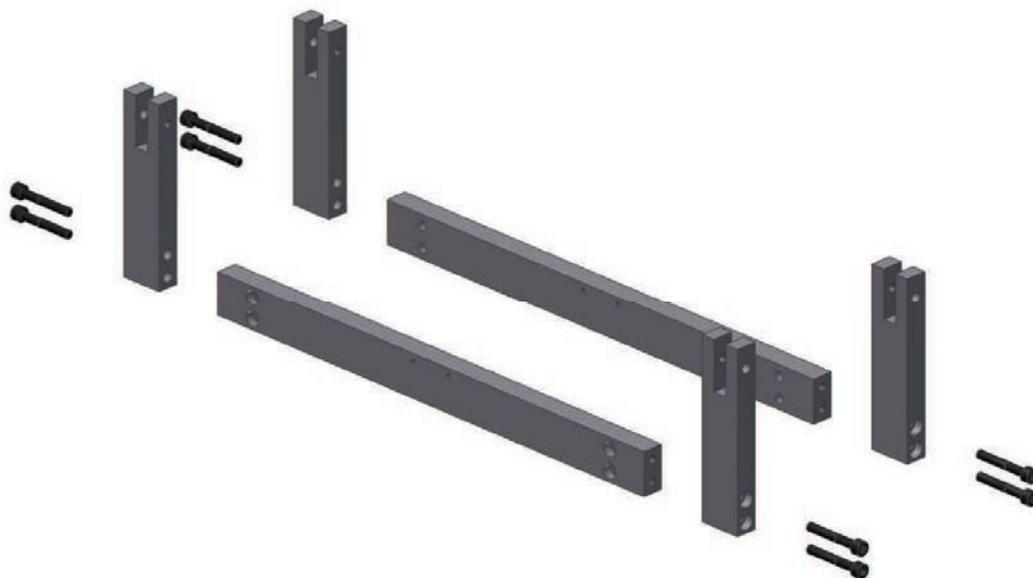
Figura 7.22. Paso nº1 del montaje de la estructura soporte.
