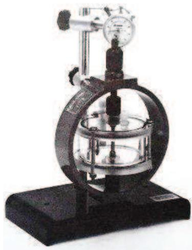
*Figura 3.1. Dispositivo de ensayo de corrosión bajo tensión usando un anillo de prueba de carga [8].*
