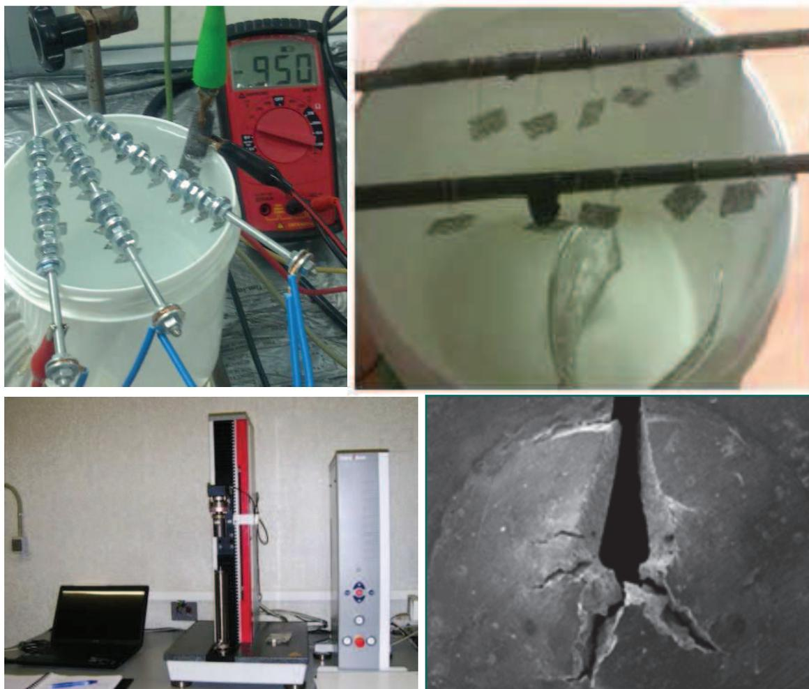
*Figura 5.2. Arriba: Probetas SPT durante su carga en H<sub>2</sub>; Abajo: máquina y utillaje de ensayo, probeta SPT entallada tras la finalización del ensayo.*
