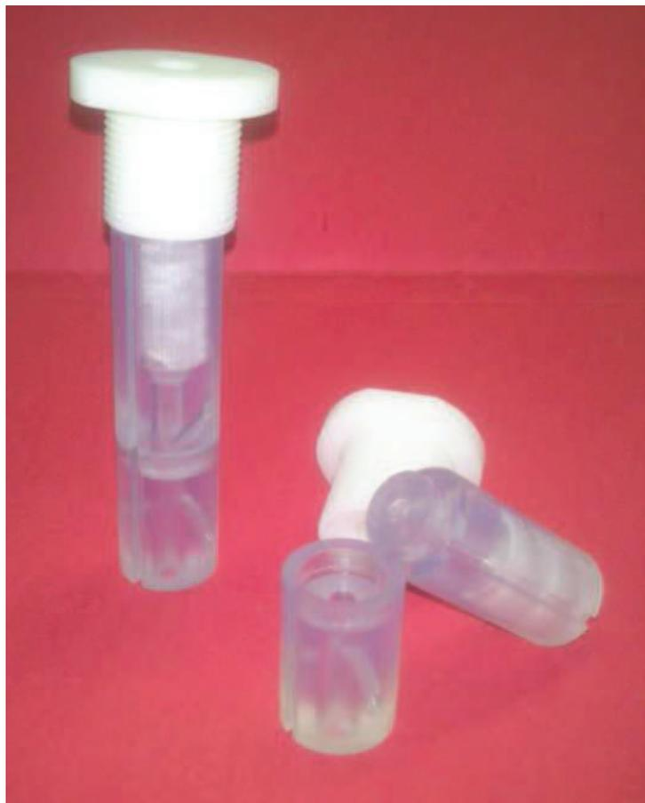
*Figura 9.4. Matrices y rosca de ABS fabricadas por la técnica de impresión 3D.*
