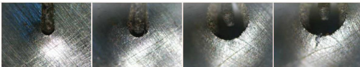
Figura 4.8. Evolución del fondo de fisura hasta el momento de la iniciación de grieta.
