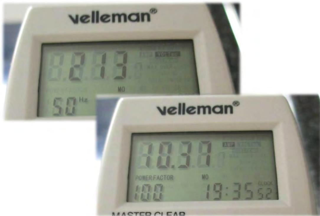
Mediciones 17. Tensión (V) e intensidad (A) de la secadora
