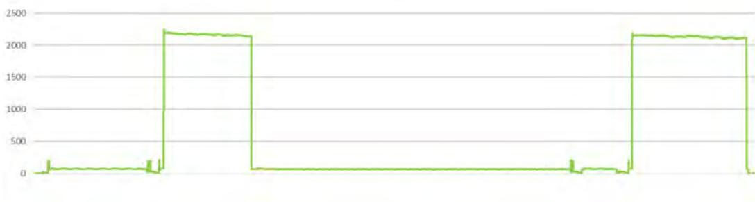
Gráfica 34. Diagrama del registro eléctrico de un lavavajillas. Fuente: <http://www.mirubee.com> 6/08/2015 19:00
