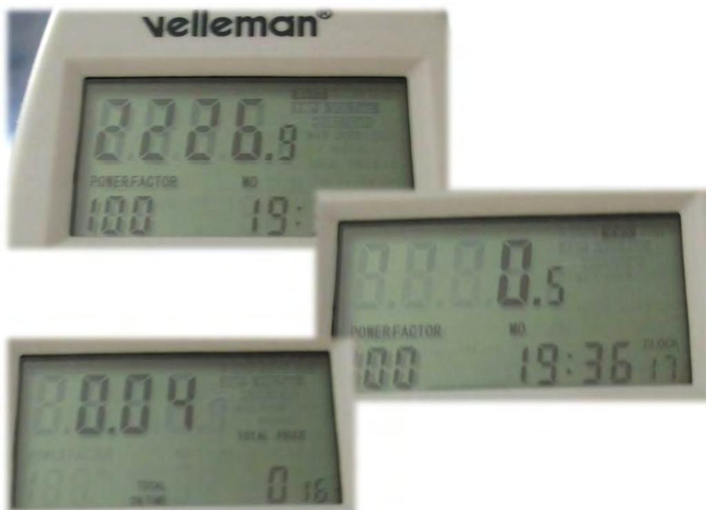
Mediciones 18. Potencia activa (W), consumo de energía (kWh) y precio total (Euros) de la secadora
