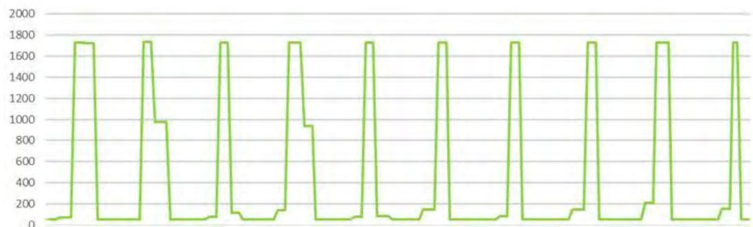
**Gráfica 32. Diagrama del registro eléctrico de un microondas. Fuente: <http://www.mirubee.com> 6/08/2015 18:55**
