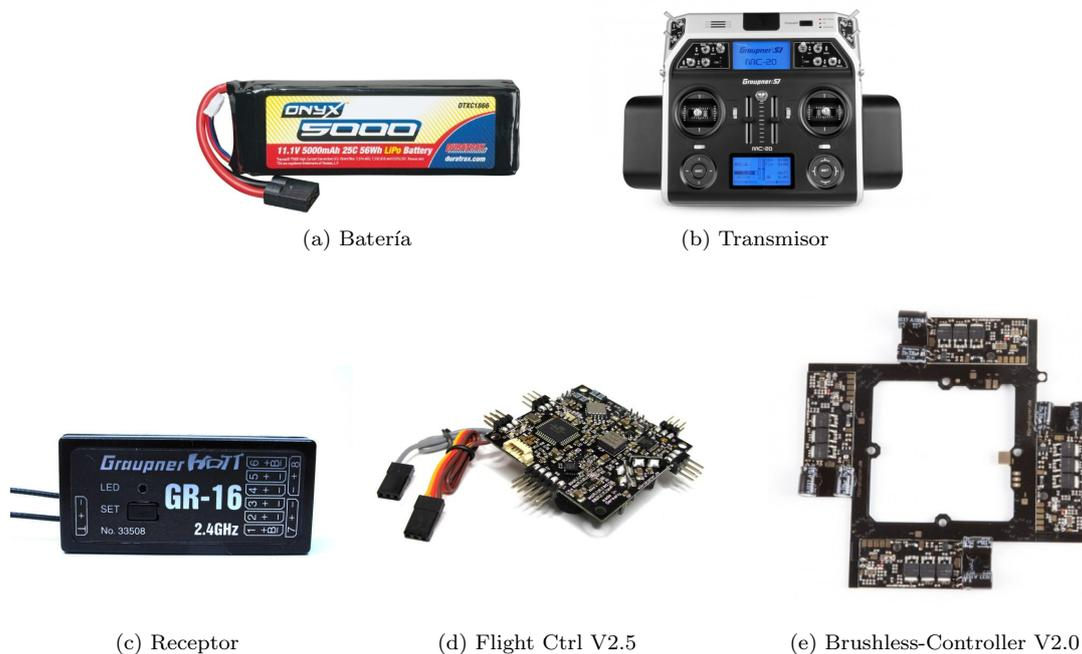
Figura 4.3: Componentes Electrónicos
