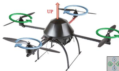
Figura 6.5: Movimiento de Elevación
