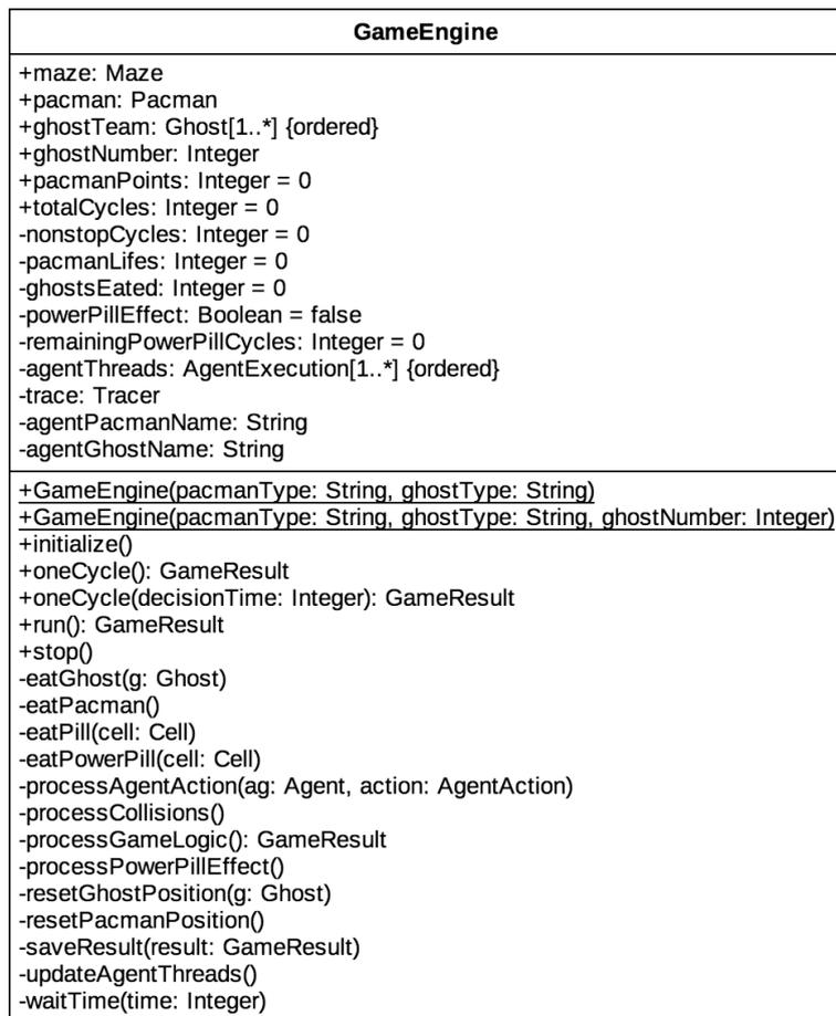
Figura 3.5: Diagrama en detalle del motor de juego
