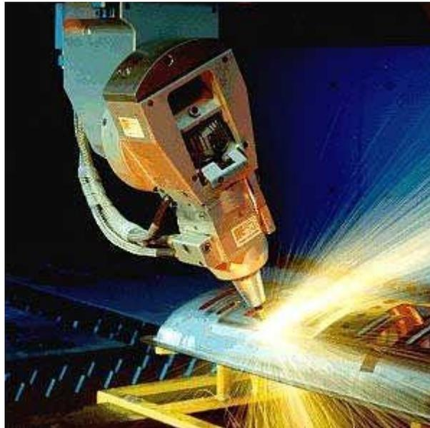
Figura 2.6 – Soldadura láser
