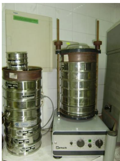
Figura 5. Distribución de tamaños de partícula mediante tamizado.
