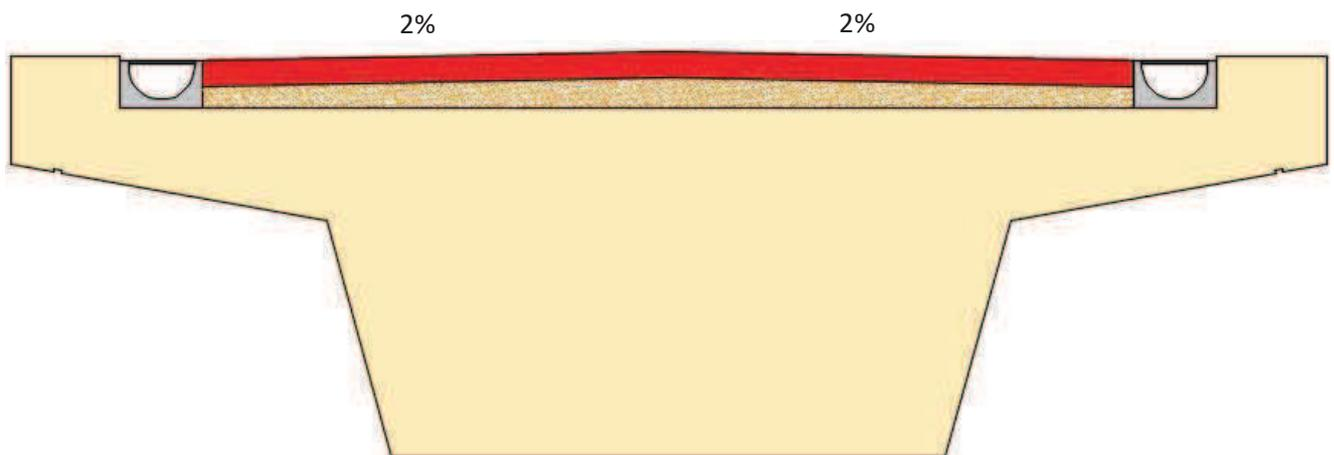
Figura 1. Sección de la pasarela con firme y drenaje
