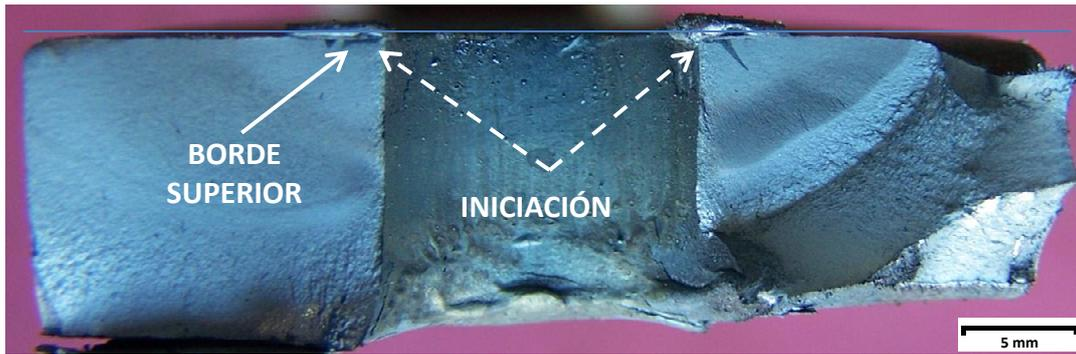
**Figura 5.61** – Rotura por fatiga en un agujero oxicortado a partir de material fundido adherido al borde superior.
