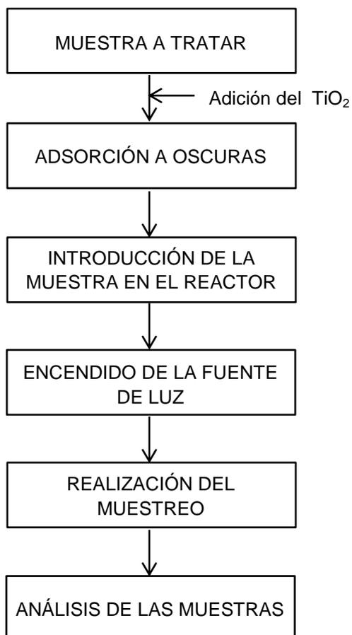
Figura 2.9. Esquema del procedimiento experimental.
