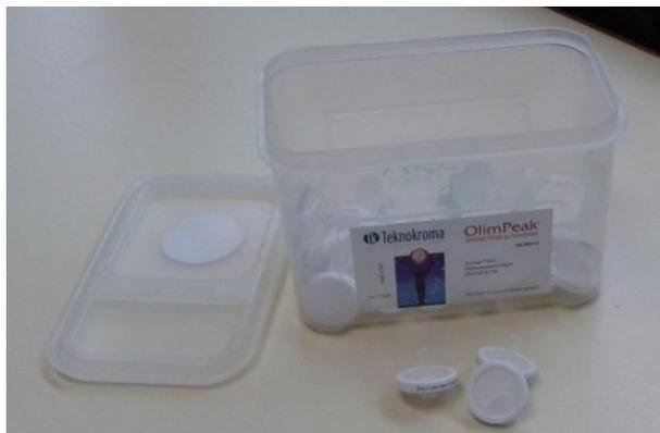
Figura 2.8. Filtros OlimPeak 45 µm.
