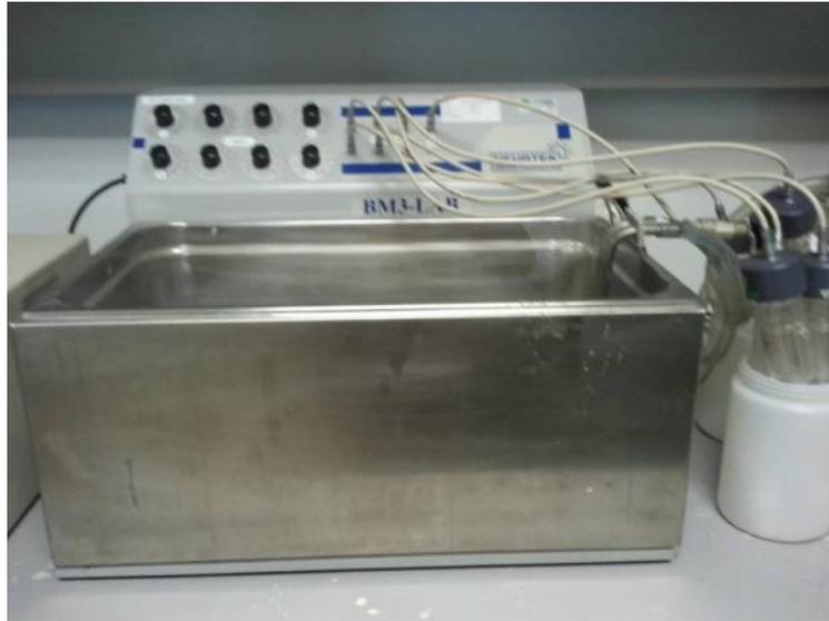
Figura 21. Respirómetro con agitación y baño termostático
