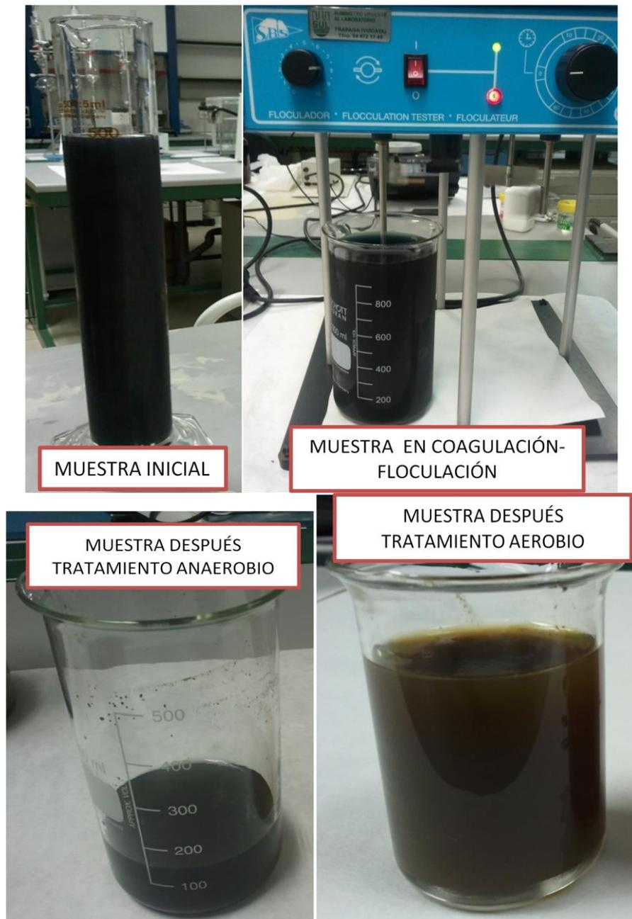
Figura 34. Agua residual en tren de tratamiento micropiloto, ensayo 2
