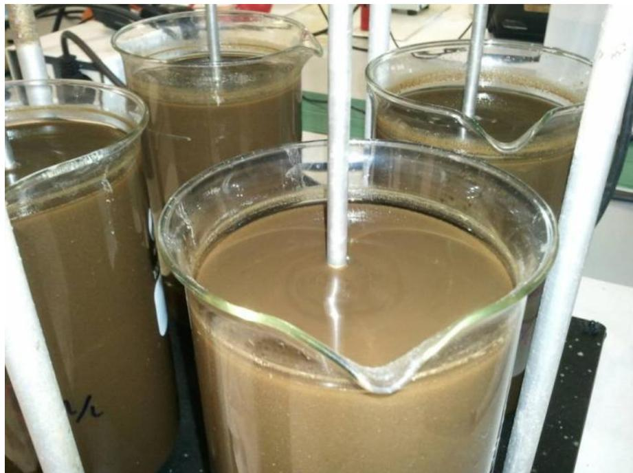
Figura 8. Sistema de agitación del Jar test
