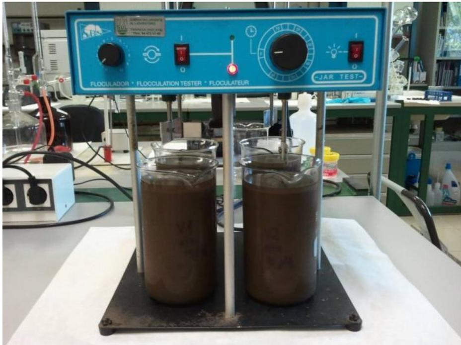
Figura 7. Ensayo Jar Test
