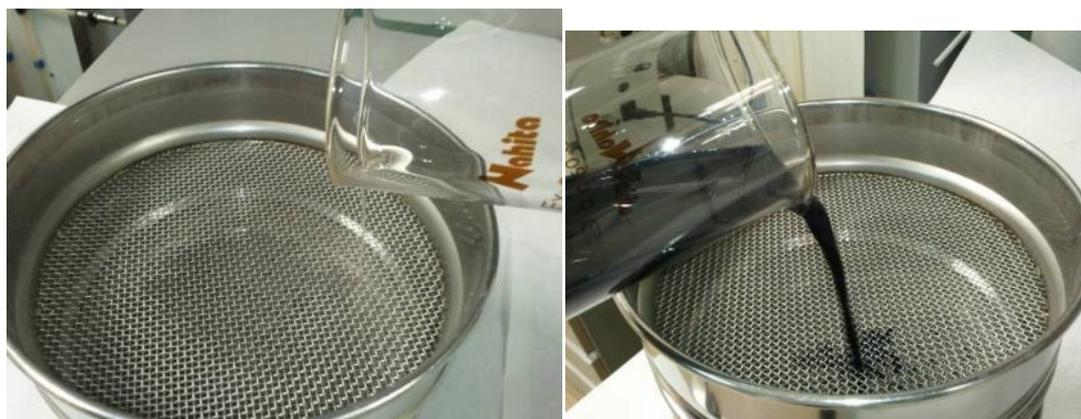
Figura 4. Filtración del agua residual industrial a través de los tamices.
