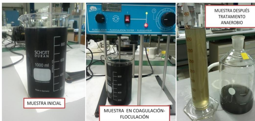
**Figura 33. Agua residual en tren de tratamiento micropiloto, ensayo 1**
