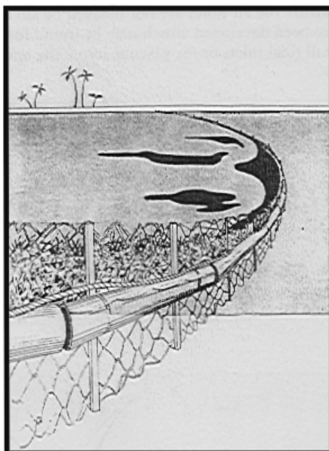
Figura 8 – Barrera improvisada construida con bambú, cabos, alambres y madera; como material absorbente se emplea paja
