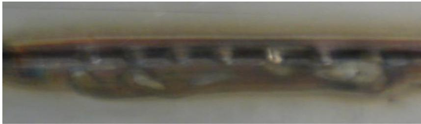
Figura 4.24 - Cordón de soldadura con varios defectos continuos.
