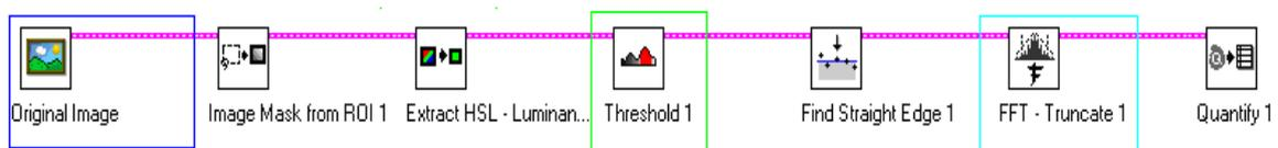
Figura 4.1 - Sistema de procesamiento de imagen, *NI Vision*.
