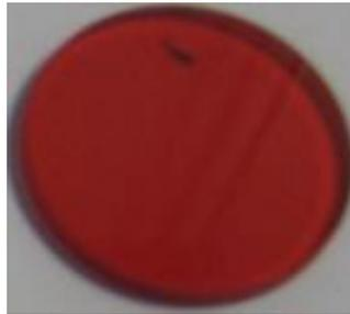
Figura 2.29 - Filtro óptico en 632nm.
