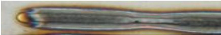
Figura 4.5 - Cordón de soldadura con bajada de intensidad.
