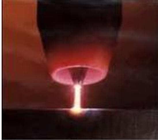
Figura 2.1 – Ejemplo del cabezal o boquilla de soldadura TIG durante el proceso.
