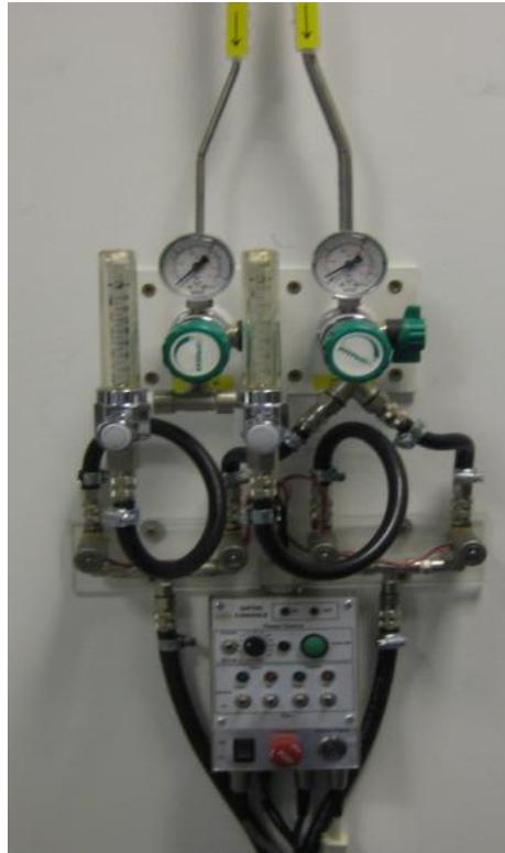
Figura 3.1 – Sistema del gas de protección.
