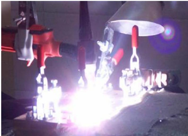
Figura 2.2 - Ejemplo del proceso de soldadura de arco a TIG con su correspondiente radiación de plasma generado.
