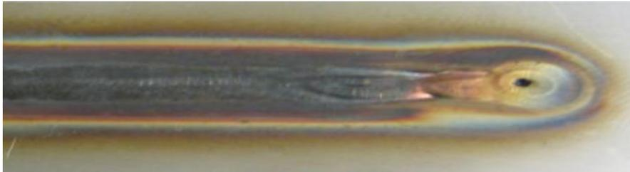
Figura 4.12 - Cordón de soldadura con aparición de un cráter.
