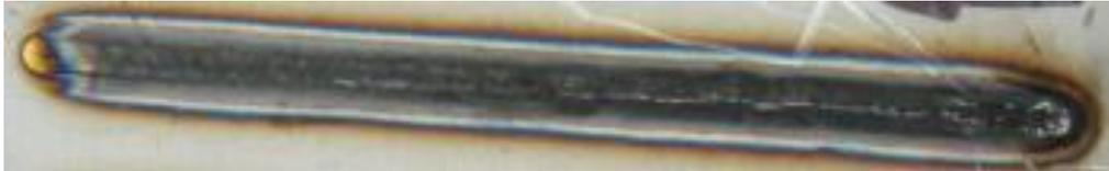
Figura 4.2 - Cordón de soldadura correcta.
