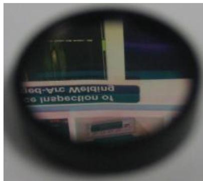
Figura 2.21 - Filtro óptico en 532nm.
