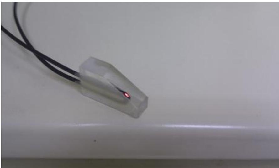
*Figura 4.1. Sensor de fibra óptica basado en pérdidas por curvatura fabricado sobre metacrilato.*
