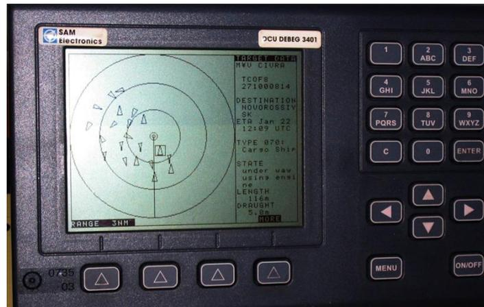
Figura 4: Automatic Information System (AIS). Fuente: Clipper
