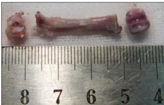
Figura 30: Muestra para los estudios biomecánicos; división de las epífisis para estudio de micro-indentación y de la diáfisis los ensayos de máxima flexión en cuatro puntos.
