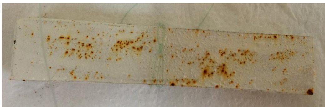
Figura 130. Probeta E tras un mes en agua de mar
