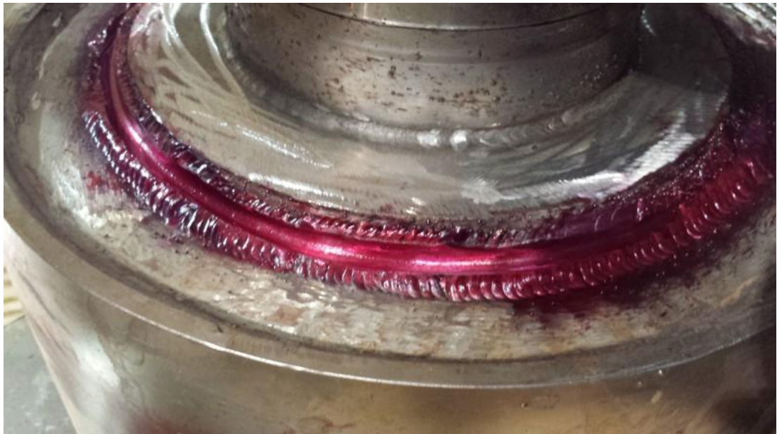
Figura 33. Pieza preparada para realizar el ensayo con líquidos penetrantes
