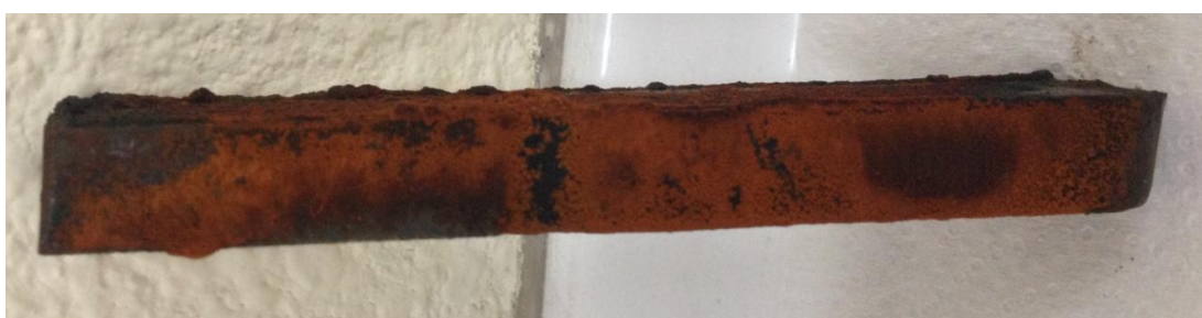
Figura 104. Probeta tras dos semanas en agua de mar
