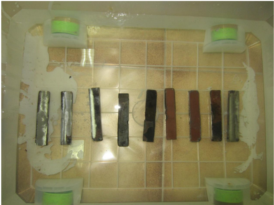
Figura 102. Probetas de acero de construcción naval sumergidas en agua de mar
