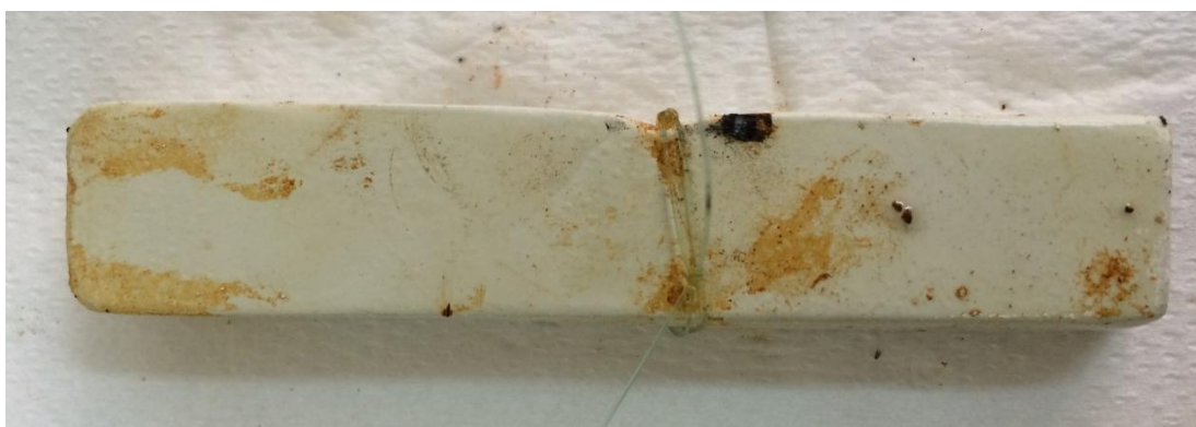
Figura 120. Probeta A tras 8 meses sumergida en agua de mar
