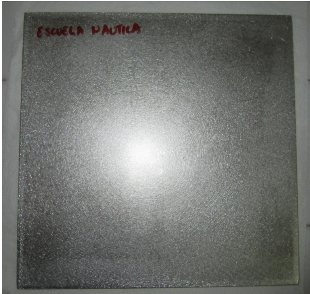
Figura 137. Probeta de aluminio antes de ser sumergida
