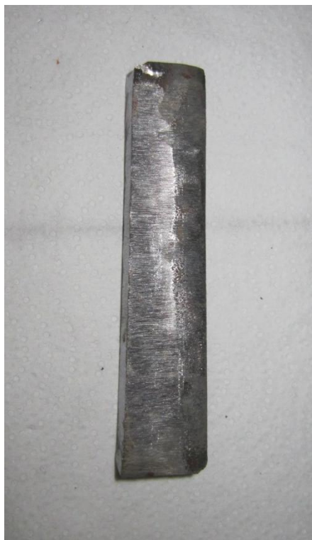
Figura 81. Probeta de acero de construcción naval AH36
