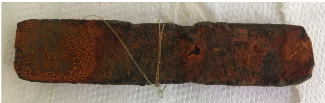
Figura 125. Probeta C tras seis meses en agua de mar
