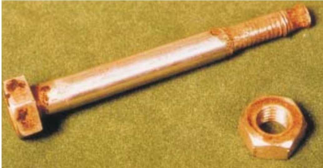
Figura 63. Tornillo y tuerca que presentan corrosión en resquicios [ http://www.labcyp.com/admin/15.pdf ]
