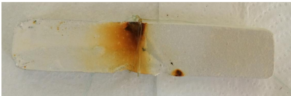
Figura 121. Probeta B tras un mes en agua de mar
