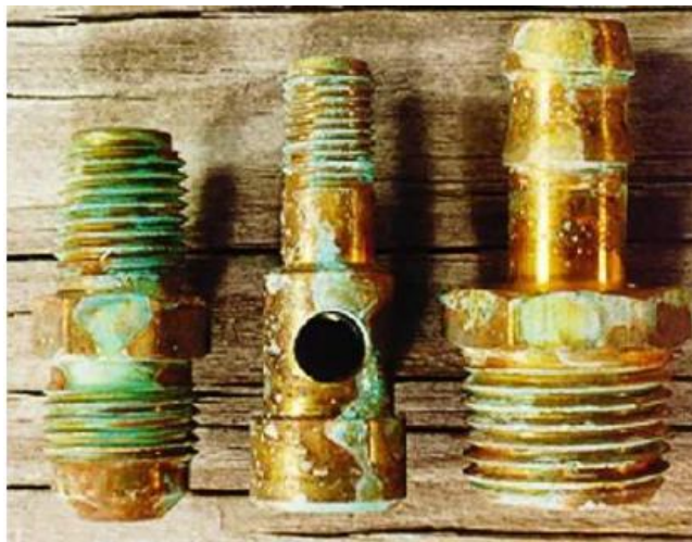
Figura 60. Ejemplo de la descincificación del latón
