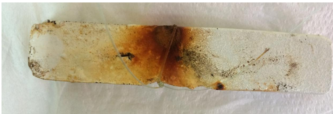
Figura 123. Probeta B tras 8 meses sumergida en agua de mar
