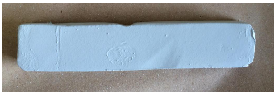
Figura 106. Probeta pintada con dos capas de imprimación
