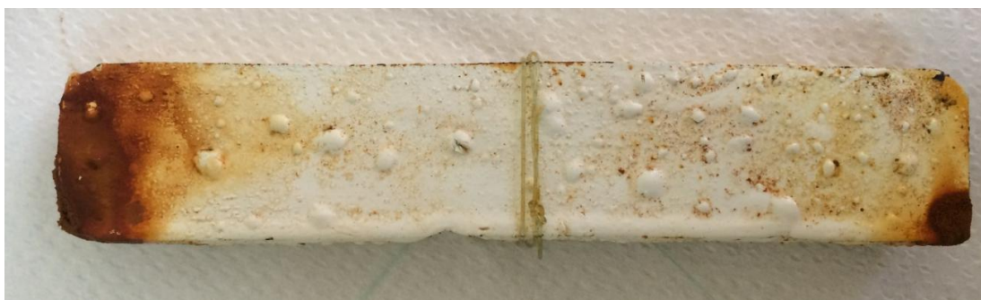
Figura 128. Probeta D tras seis meses en agua de mar
