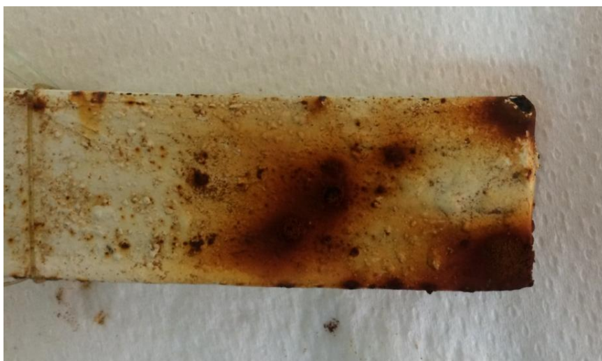
Figura 129. Detalle de la probeta D tras 8 meses sumergida en agua de mar
