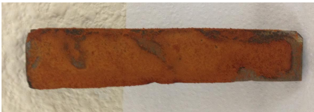
Figura 103. Probeta tras una semana en agua de mar
