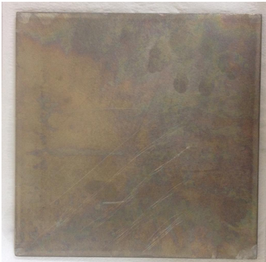
Figura 140. Probeta de aluminio tras 4 meses sumergida
