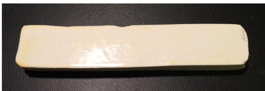
Figura 107. Probeta del Grupo A con dos capas de imprimación y dos de pintura epoxi
