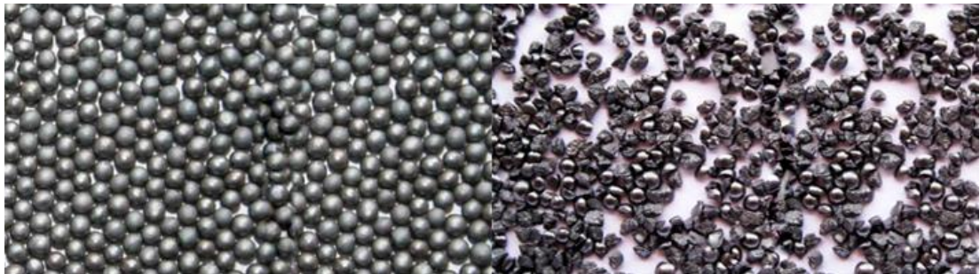
Figura 76. Granalla empleada en el proceso de chorreado con granalla
