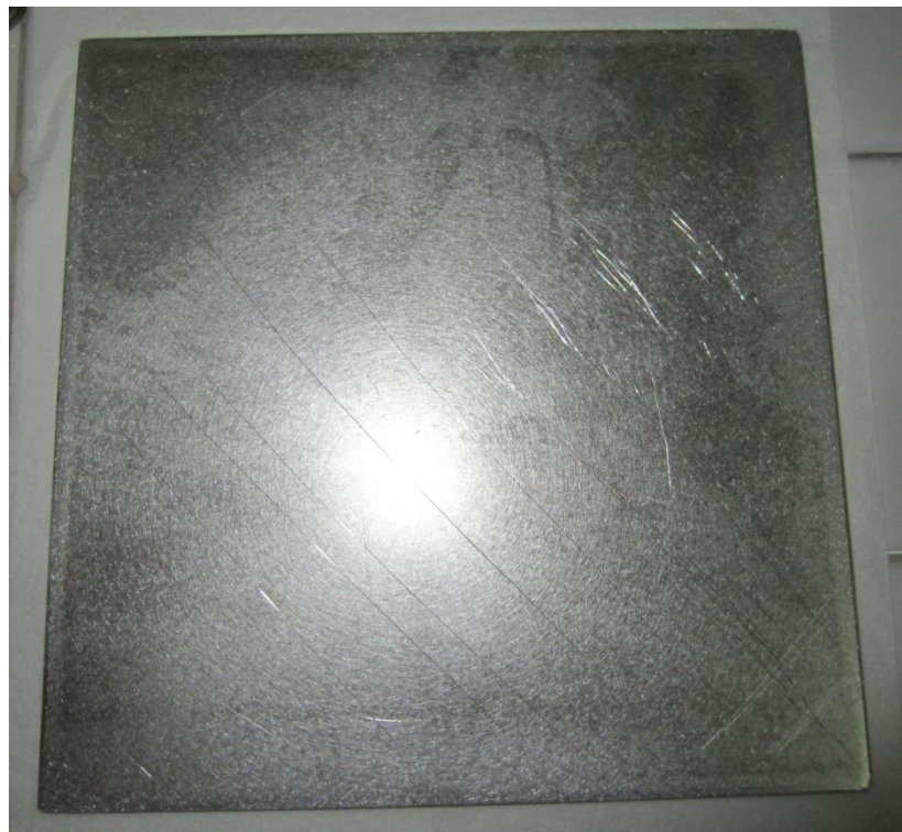
Figura 82. Probeta de aluminio 5083 empleado en el estudio de la corrosión
