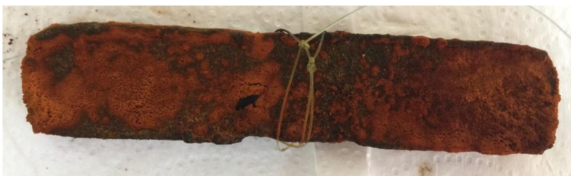
Figura 124. Probeta C tras un mes en agua de mar
