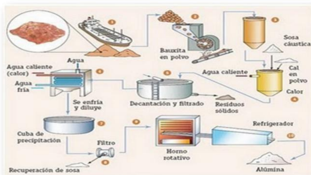
Figura 15. Proceso de obtención del aluminio
