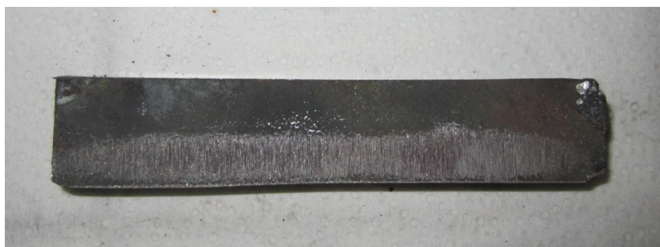
Figura 101. Probeta tipo empleada en el estudio de la corrosión
