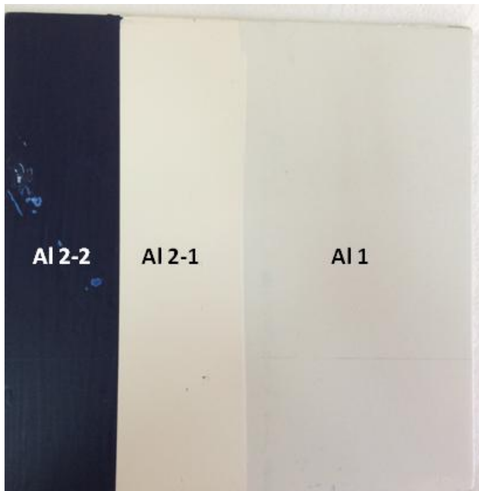
Figura 141.Subdivisiones de la probeta de aluminio
