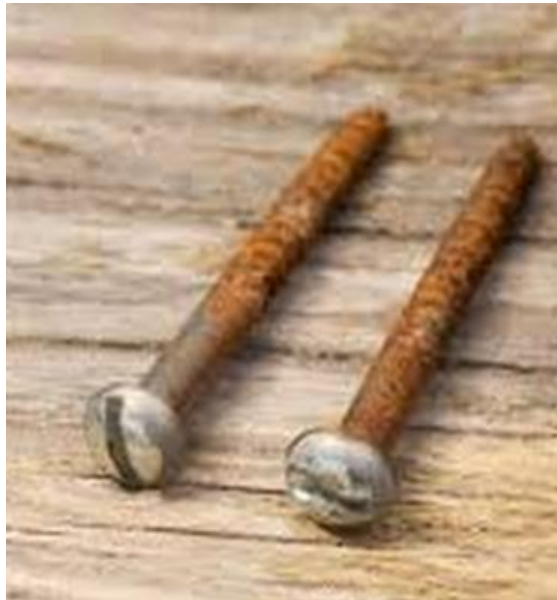
Figura 65. Tornillos que han sufrido una corrosión por fatiga [ http://repositorio.espe.edu.ec/bitstream/21000/8704/1/T-ESPE-ITSA-000180.pdf ]
