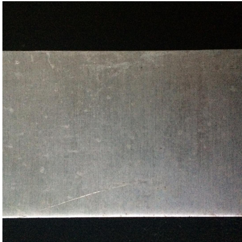
Figura 58. Picaduras en pieza una pieza de aluminio
