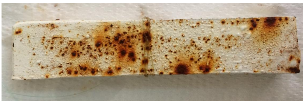
Figura 131. Probeta E tras seis meses en agua de mar
