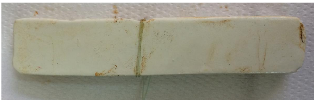
Figura 119. Probeta A tras seis meses en agua de mar
