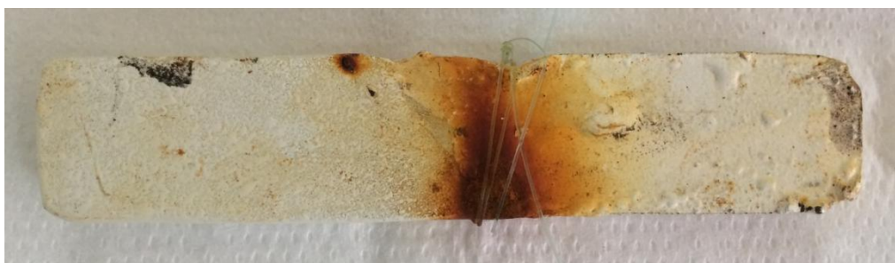
Figura 122. Probeta B tras seis meses en agua de mar
