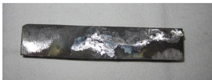
Figura.2 Probeta de acero de construcción naval empleada en este estudio
