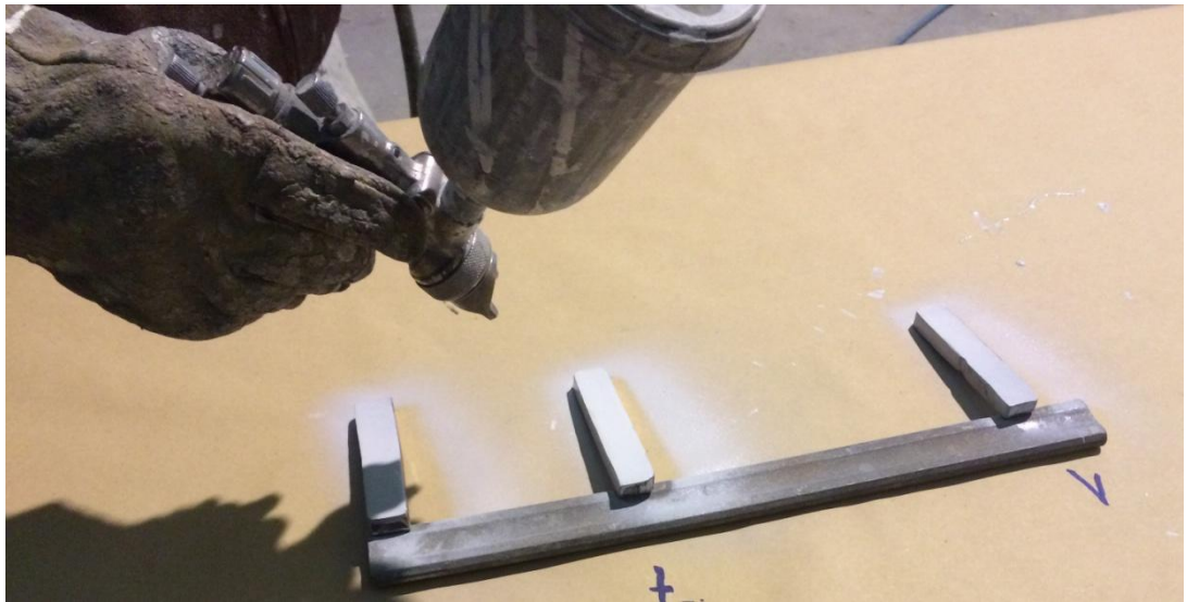
Figura 84. Probetas durante el proceso de pintado
