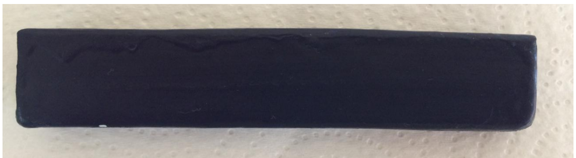
Figura 133. Probeta D tras un mes en agua de mar
