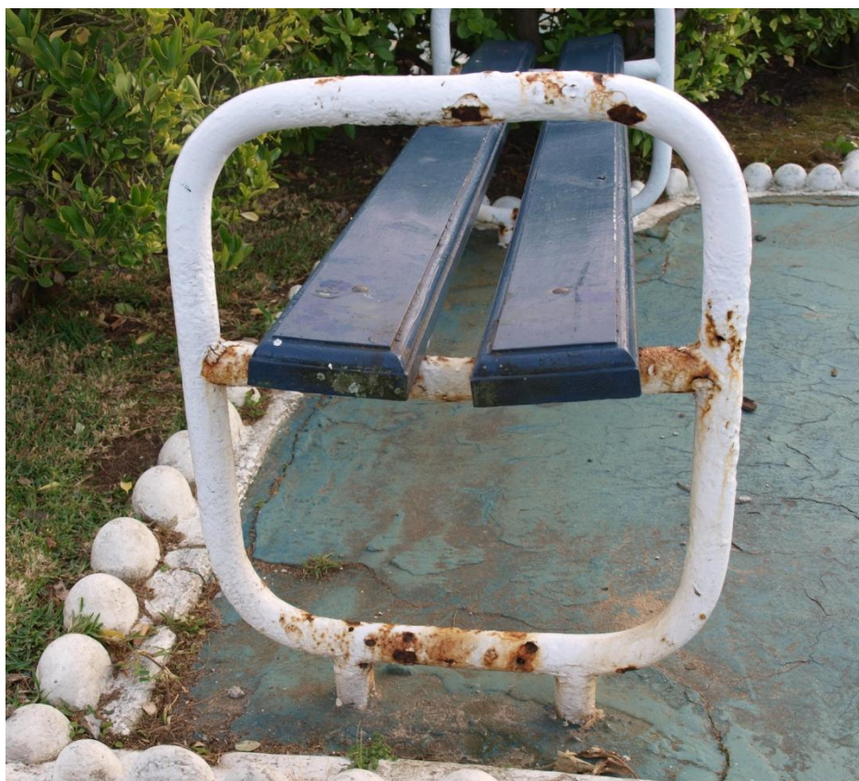
Figura 49. Corrosión en un banco en los Jardines de Piquío (Santander-Cantabria)
