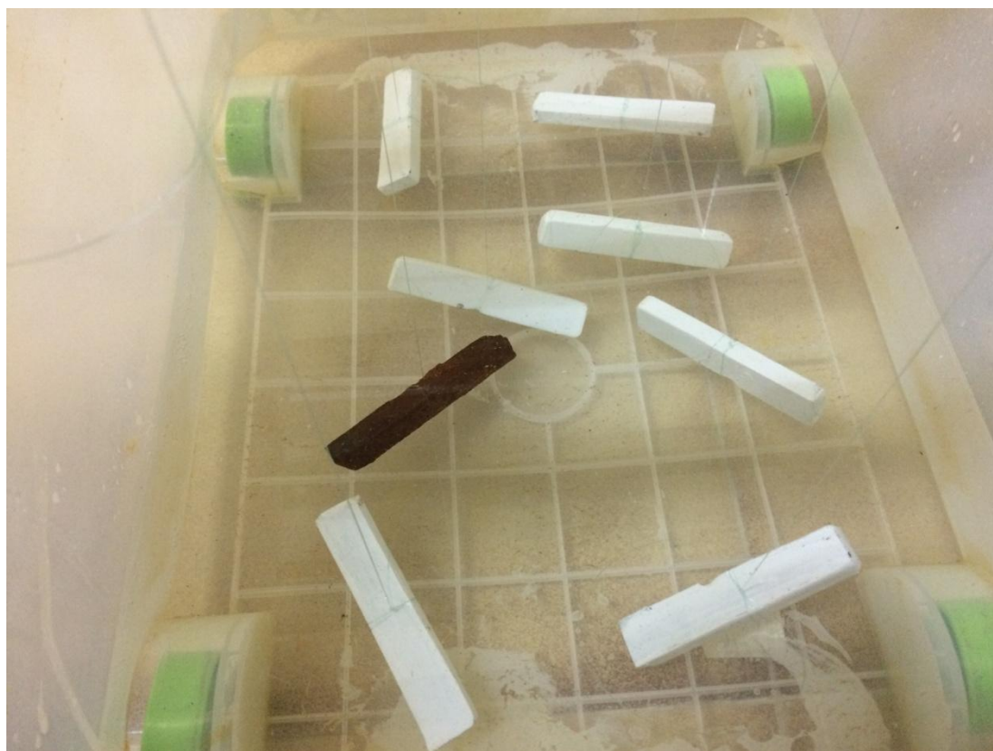
Figura 117. Probetas de acero de construcción naval sumergidas en agua de mar tras recibir un tratamiento a base de pinturas marinas
