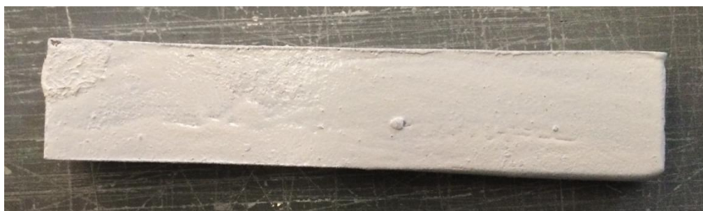
Figura 114. Probeta E tras la aplicación de todas las capas de pintura
