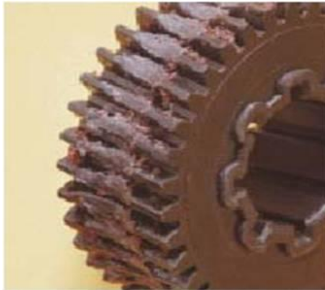
Figura 66. Ejemplo de corrosión por fricción
