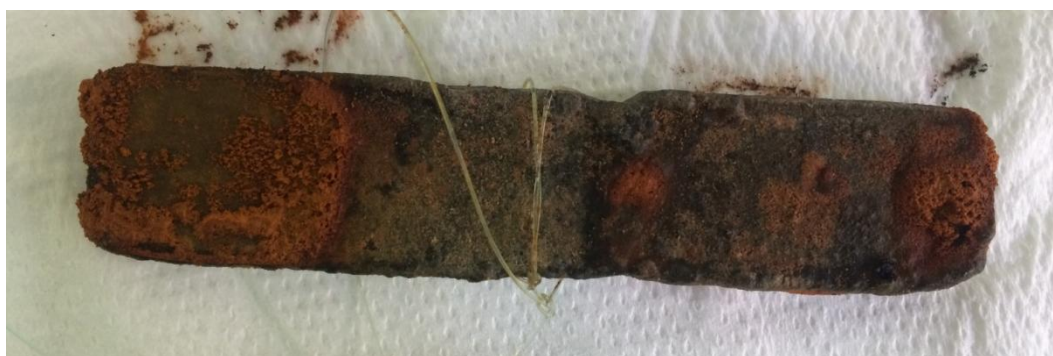
Figura 126. Probeta C tras 8 meses sumergida en agua de mar
