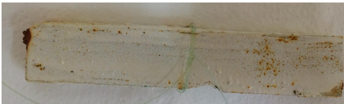
Figura 127. Probeta D tras un mes en agua de mar
