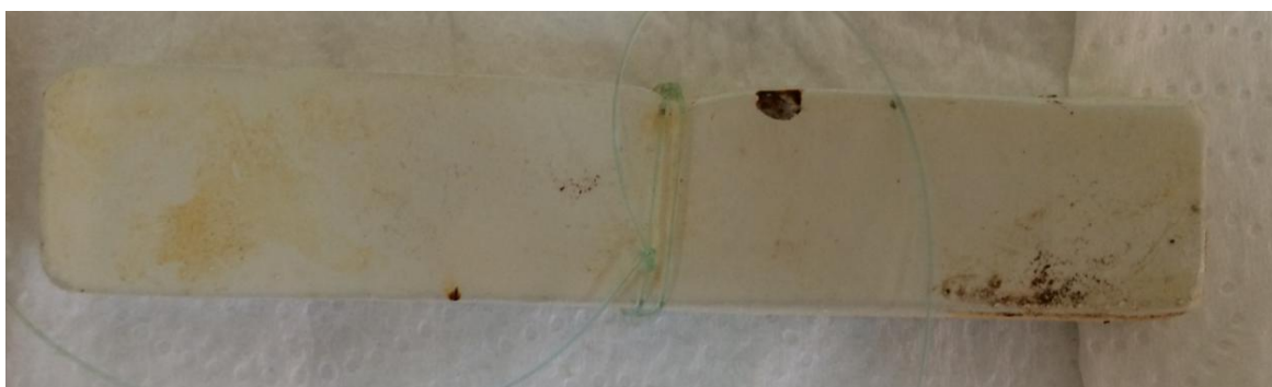
Figura 118. Probeta A tras un mes en agua de mar
