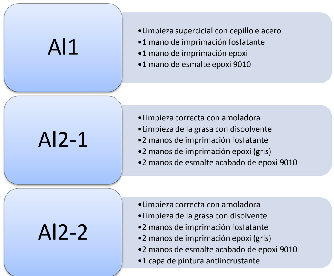
Figura 97. Esquema de pintado de la pieza de aluminio
