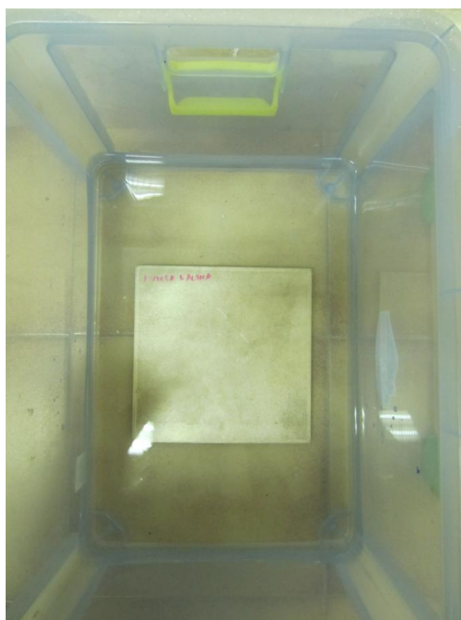
Figura 139. Probeta de aluminio sumergida en agua de mar
