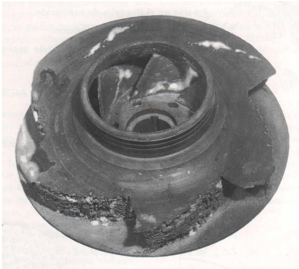
Figura 62. Elemento metálico que ha sufrido corrosión por cavitación [ https://areamecanica.wordpress.com/2011/07/28/ingenieria-mecanica-la-cavitacion-en-bombas-centrifugas/ ]
