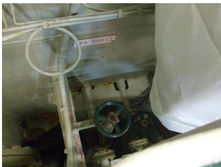
**Ilustración 34-Inyección toma de mar alta estribor**
