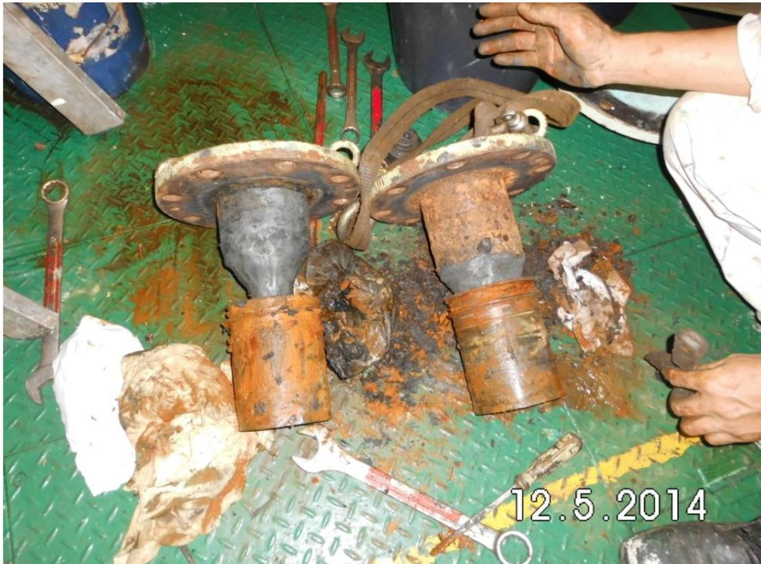
Ilustración 10- Desgaste prematuro de los ánodos
