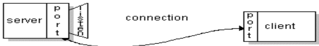
Figure 6-2: Server accettando la conessione con il cliente in un socket
