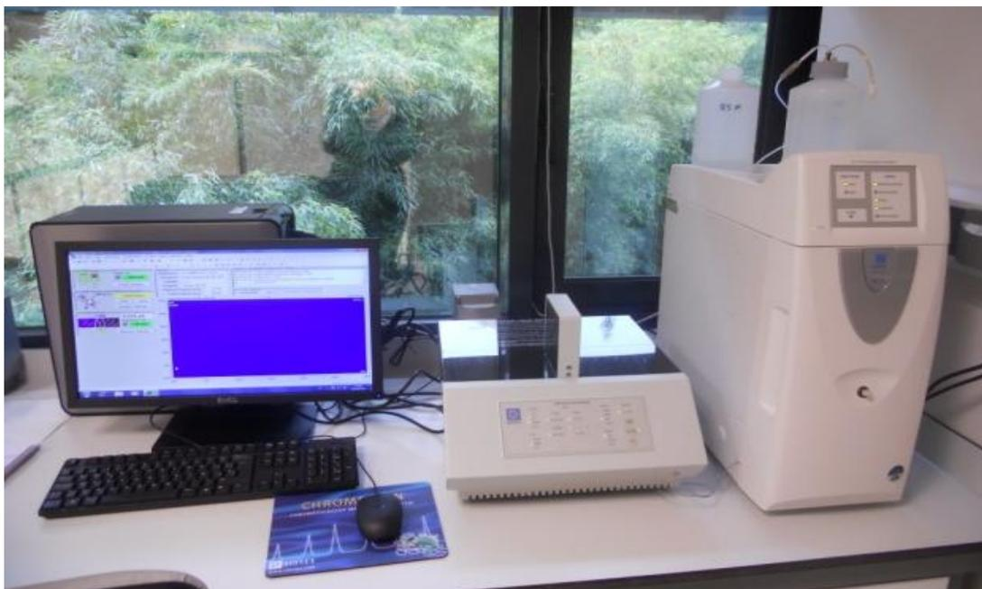
**Figura 3.6.** ICS-1100 utilizado para el análisis por cromatografía iónica
