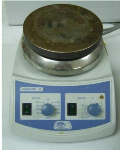
**Figura 3.1.** Placa agitadora-calefactora P Selecta Agimatic-N
