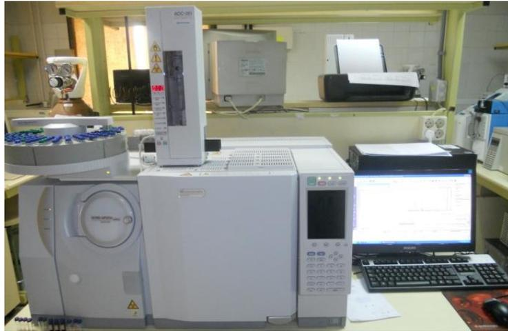
**Figura 3.10.** Cromatógrafo Shimadzu 2010 Plus
