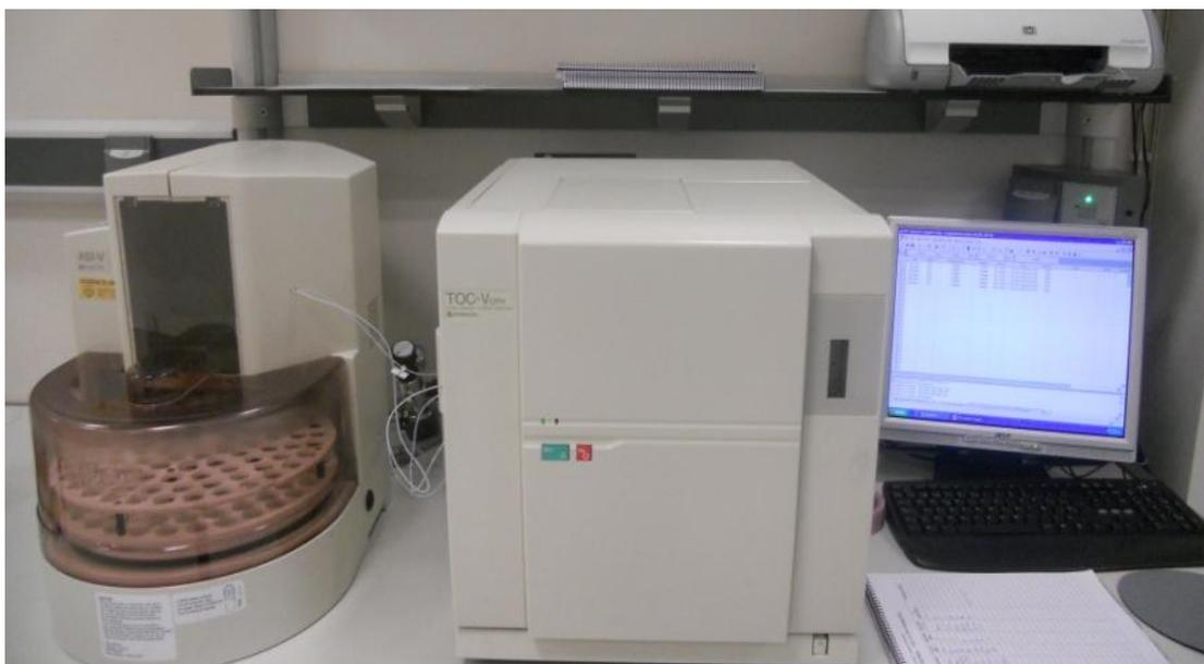
**Figura 3.5.** TOC-V Shimadzu utilizado para el análisis del COT
