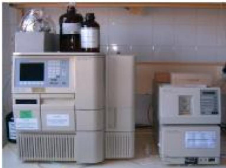
**Figura 3.8.** Cromatógrafo HPLC Waters 2690
