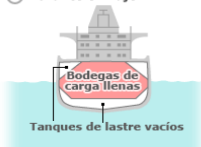
Figura 3 - Ciclo de las aguas de lastre (Fuente: Globallast)
