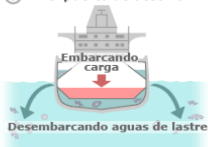
Figura 3 - Ciclo de las aguas de lastre (Fuente: Globallast)
