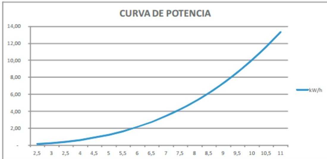
Imagen 2. Curva de potencia del aerogenerador elegido.
