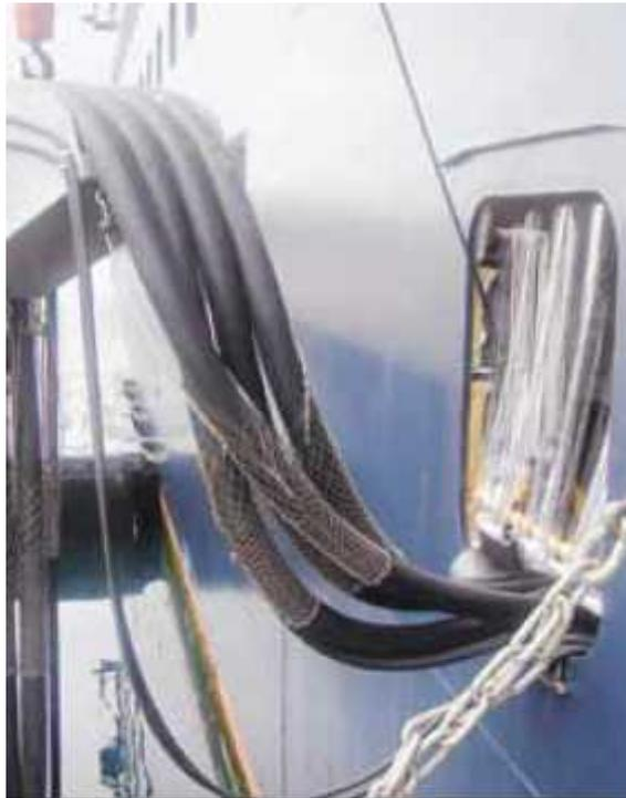
IMAGEN 48: Cables de conexión del buque Oosterdam de compañía Holland America Line
