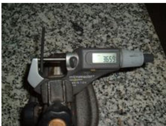
Imagen 2. Micrómetro para medición de diámetro.
