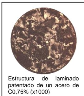
Estructura de laminado patentado de un acero de C0,75% (x1000)
