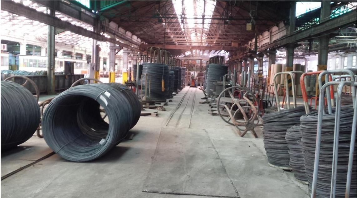
Fotografía 2. Rollos cargados en argadillos antes de ser patentados.
