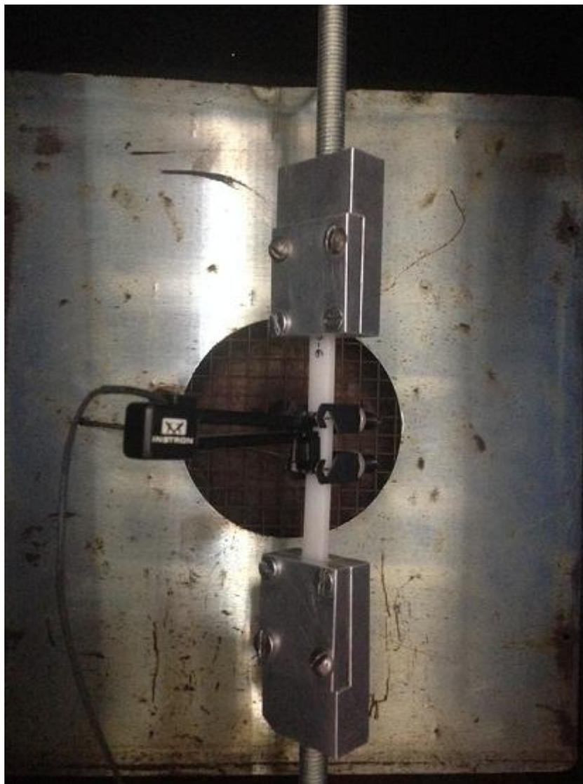
Figura 46.2. Probeta en ensayo de fluencia en cámara ambiental.
