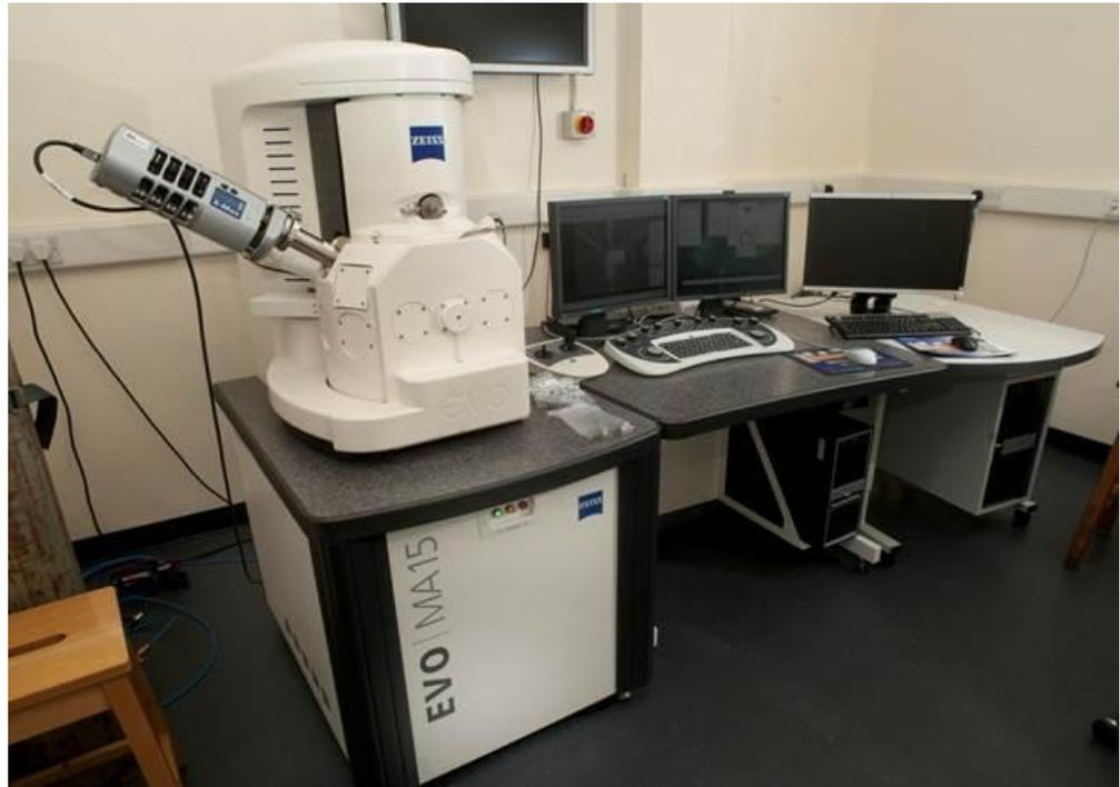
Figura 43. Microscopio electrónico de barrido ZEISS EVO MA15.
