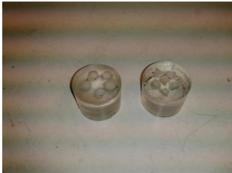
Figura 44. Muestras de probeta embutidas en glicol.
