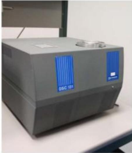
Figura 33. Equipo utilizado para el ensayo, DSC 131.
