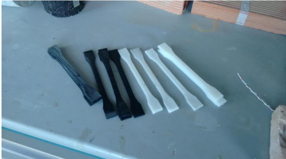
Figura 41. Ejemplo de probetas inyectadas de PA con refuerzo y sin refuerzo.
