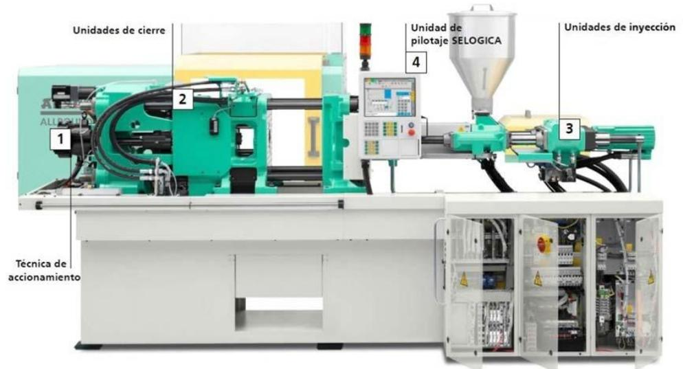
Figura 38. Máquina de Inyección ARBURG ALLROUNDER 221K 350-100.
