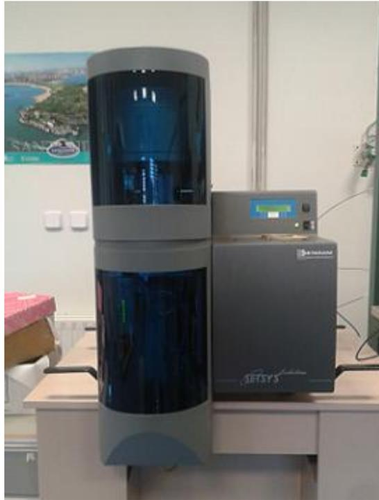
Figura 34. Equipo utilizado para el ensayo de termogravimetría, Setaram TG-DSC Setsys.
