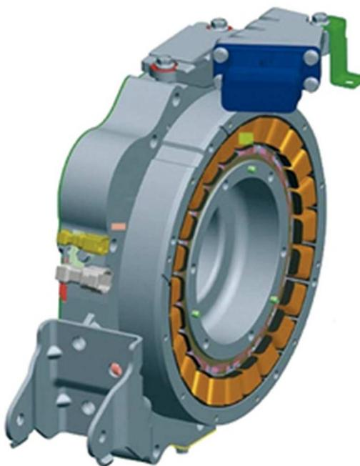
Figura 5.3. Generador síncrono de imanes permanentes.
