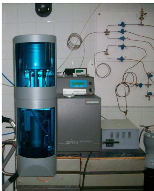
**Figura 2.4.** Equipo termogravimétrico.
