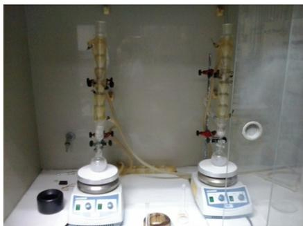
**Figura 2.2.** Esquema del tratamiento ácido post-síntesis a reflujo del material MCM41.
