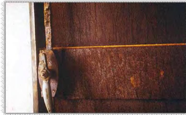
Fig. 12. Corrosión uniforme en puerta
