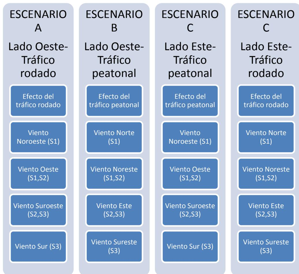
Fig. 110. Factores, de cada escenario, que favorecen el fenómeno de la corrosión
