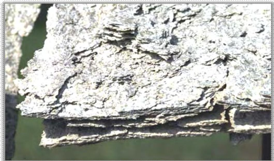
Fig. 25. Corrosión por exfoliación
