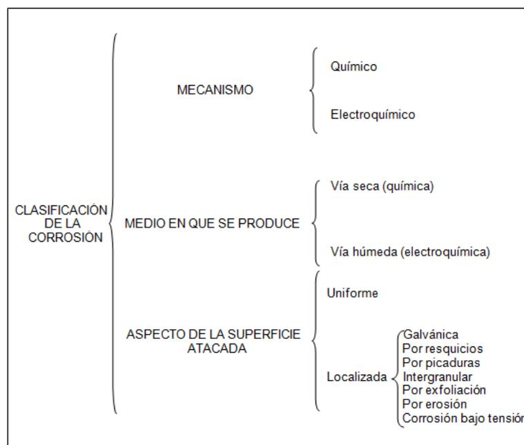
Figura 11. Clasificación de la corrosión
