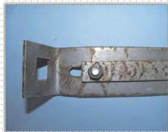
Fig. 20. Corrosión por resquicios
